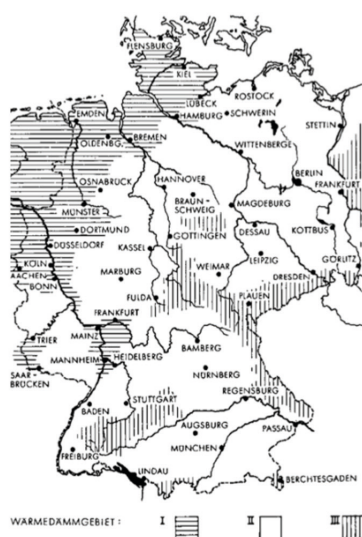
Abb. 5: Wärmedämmgebiete I, II und III gemäß DIN 4108:1952-07
