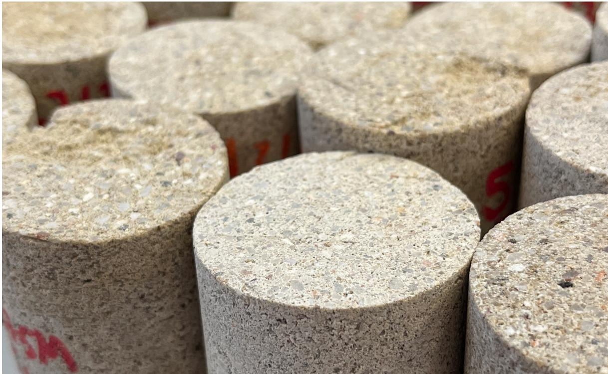
Im aktuellen Projekt hergestellte Probekörper aus Biobeton, Bild-Quelle: ILEK
