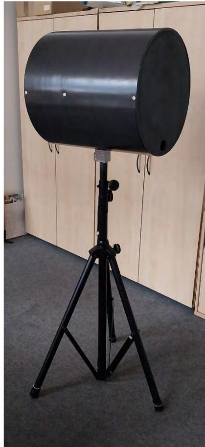
**Abb 1.** Das im Aufbau befindliche RSL4 Messsystem mit einer Rotationsvorrichtung und Halterungen für 4 Detektoren in einer Kohlefasertubus-Umhausung. Auf der Vorderseite ist eine Weitwinkelkamera angebracht.
