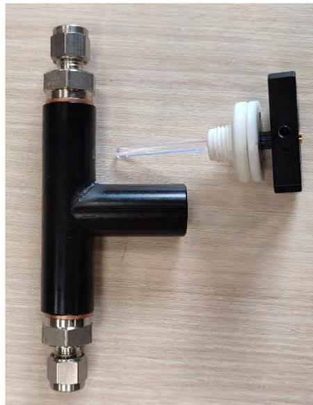
Abbildung 10: Konstruierte Testanordnung mit Swagelok-Anschlüssen und Detektoranordnung.
