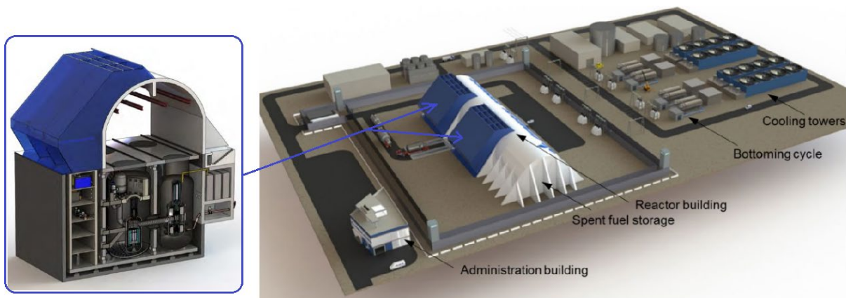
Abb. 2.1 Skizze einer Anlage mit vier EM 2 Reaktormodulen (rechts) und Schnittdarstellung eines Reaktorgebäudes (links) (modifiziert nach /IAE 19/ und /IAE 20/)
