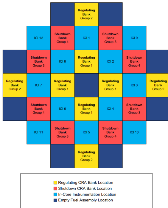
Abb. 3.1 Position der Steuerelemente innerhalb eines NPM Kerns /NDA 04/
