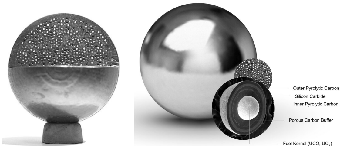
Abb. 2.3 Brennstoffkugel (links) und TRISO-X-beschichtete Partikel (rechts) /XEN 22b/
