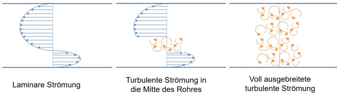
**Abb. 2.30** Geschwindigkeitsprofile bei Gegenströmung – laminare Strömung, teilweise turbulente Strömung und voll ausgebreitete turbulente Strömung
