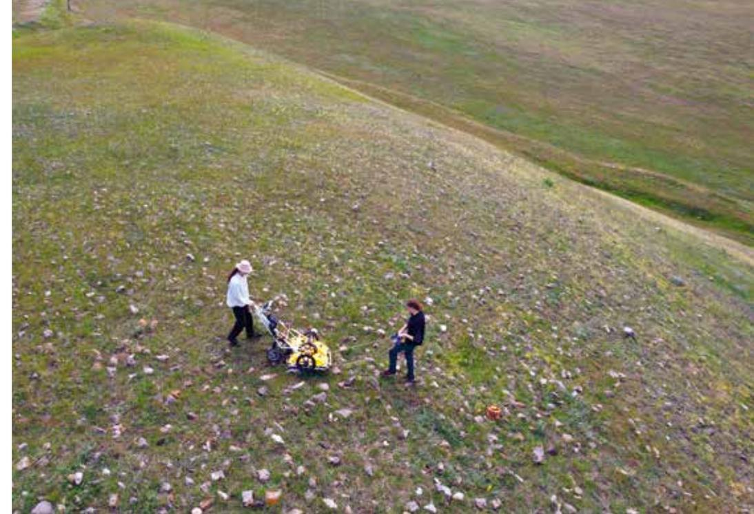
Georadarmessung mit dem System PulseEKKO durch die Firma Eastern Atlas, Berlin.
