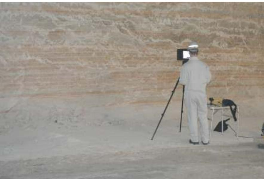
Testmessung mit dem Thermographie-Demonstrator in einem Kalisalz-Bergwerk.
