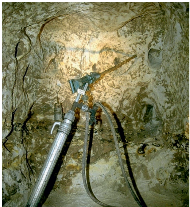
Bohrvorrichtung (Flottmannbohrer) Pressluft für Bohrer und Zylinder
