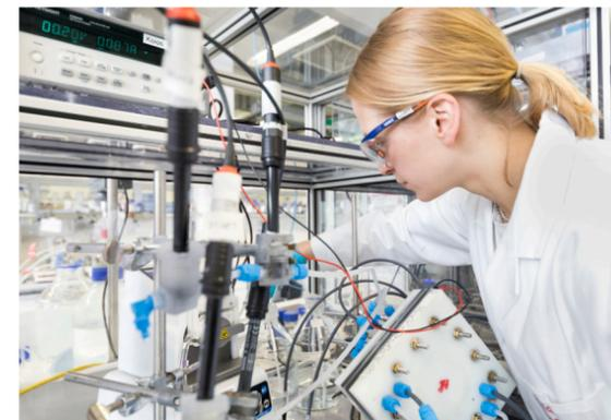
Aufbau einer Anlage zur kapazitiven Entsalzung mit Durchflusselektroden (FCDI). FCDI ist eine innovative elektrochemische Technologie zur Ionen-Wasser-Trennung mit hoher Wasserrückgewinnungsrate und kann vollständig mit erneuerbarer Energie betrieben werden.
