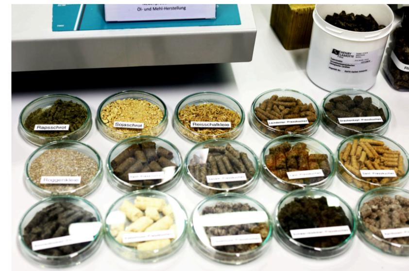
Proben aus nachwachsenden Rohstoffen, welche potentiell für die Phosphatgewinnung geeignet sind.
