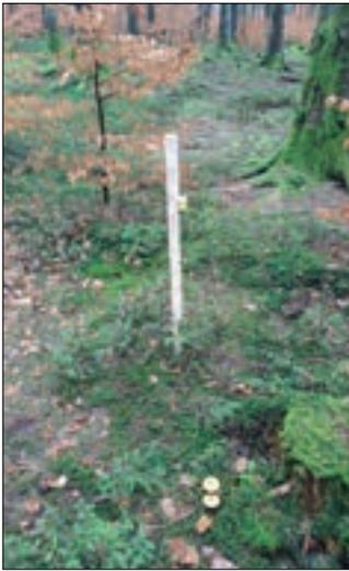
In den Untersuchungsflächen wurden im Frühjahr Klimalogger installiert, um Luftfeuchte und Temperatur zu messen.
