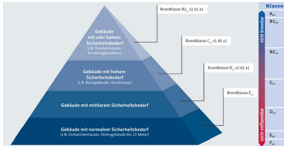
Source: BMVI (2021). ‚Bausteine für Netzinfrastrukturen von Gebäuden: Eine Handreichung der PG-Technik der UAG Inhouse des Bundesministeriums für Verkehr und digitale Infrastruktur.‘ pp.46-47 (originally from the Gigabitbüro des Bundes, modified from: ZVEI e. V. „White Paper: Brandschutzkabel erhöhen die Sicherheit“ vom August 2018).
