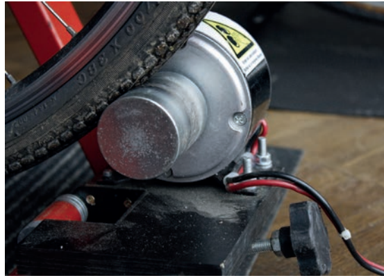
Mit dem Rollentrainer erzeugen die Kinobesucher den Strom für den Filmprojektor. Ohne Strampeln kein Film.
