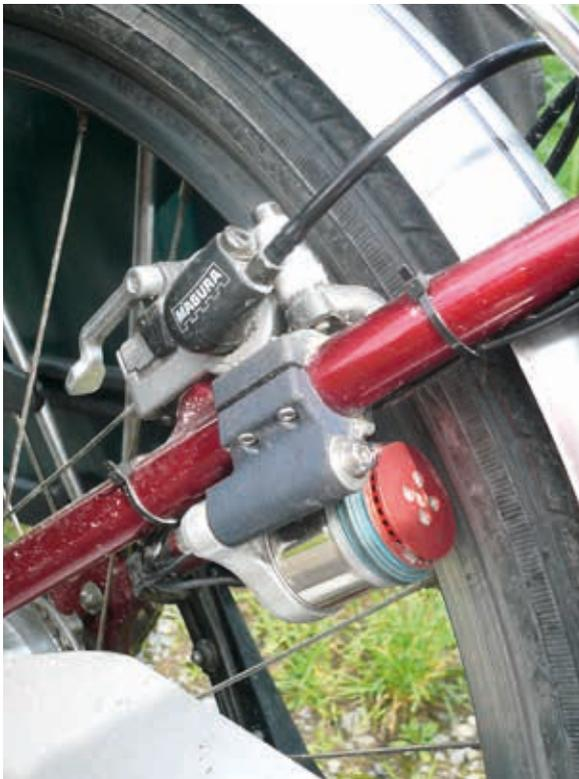
*Hier sieht man einen der beiden Motoren etwas deutlicher: Das Pendant sitzt auf der anderen Seite. Nur im eingeschalteten Zustand klappen die Rollen auf die Felge und treiben – sofern der Sensor Pedalumdrehungen registriert – das Hinterrad an.*
