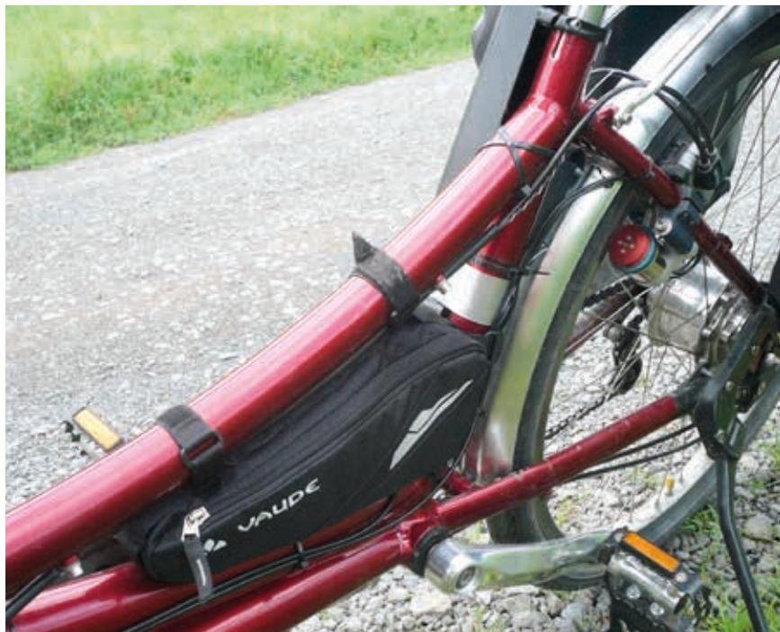
Die schwarze Vaude-Tasche beherbergt Batterie und Steuerelement. Das kleine dynamoähnliche Teil am Hinterrad ist einer der beiden Antriebsmotoren.
