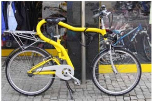
*Dieses Rad ist nicht unter eine Dampfwalze gekommen, sondern hat einen Rahmen, der sich um die Sattelstange herum schwingt. Man kann aufsteigen, ohne sein Bein über eine Mittelstange heben zu müssen.*
