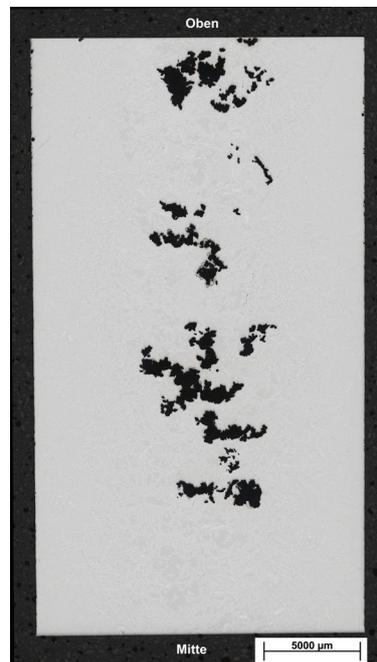
Zylinderprobe mit geringem Wasserstoffgehalt (DI = 1,7 %).
