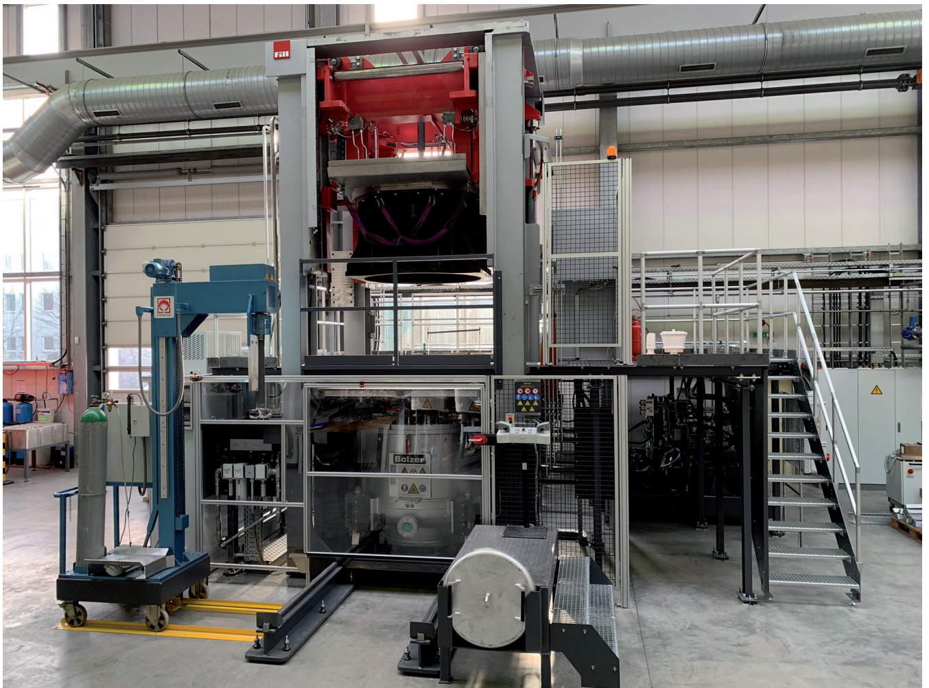
Niederdruckgießanlage „Fill Pressure Caster“ im Access TechCenter
