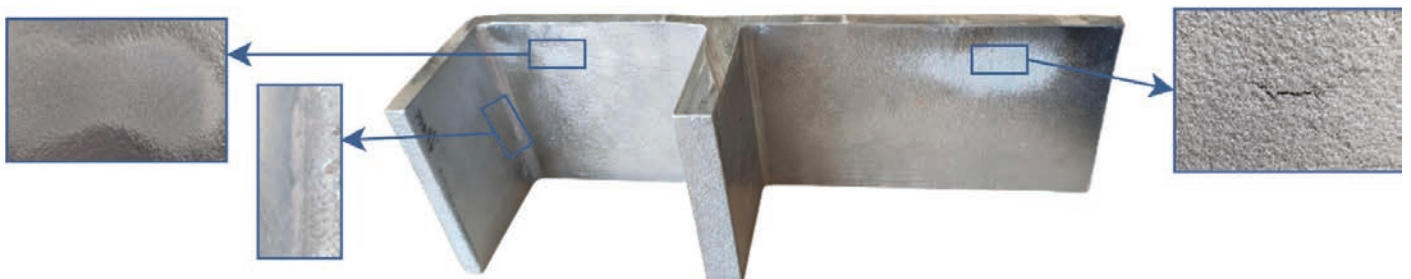
b: Heißrissvorhersage durch mikrostrukturabhängiges Kriterium
