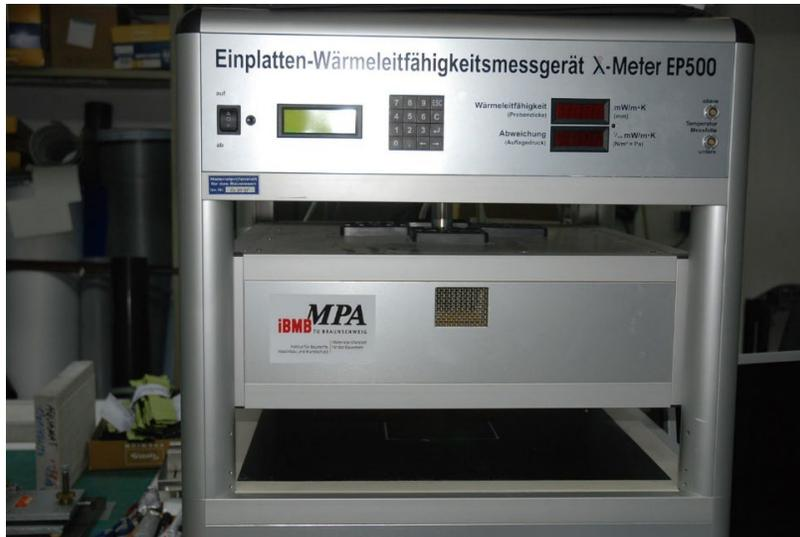
Einplattengerät DIN EN 12667
