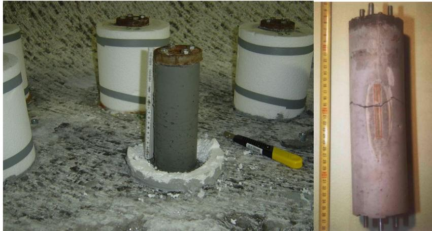
**Abb. 7** Verbundversuch Salzbeton auf Salinar (links) und Zug-Elastizitätsmodul-Probe (rechts)
