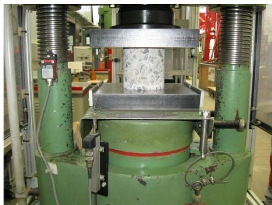
**Abb. 5** Druckprüfung an mineralischem Baustoff
