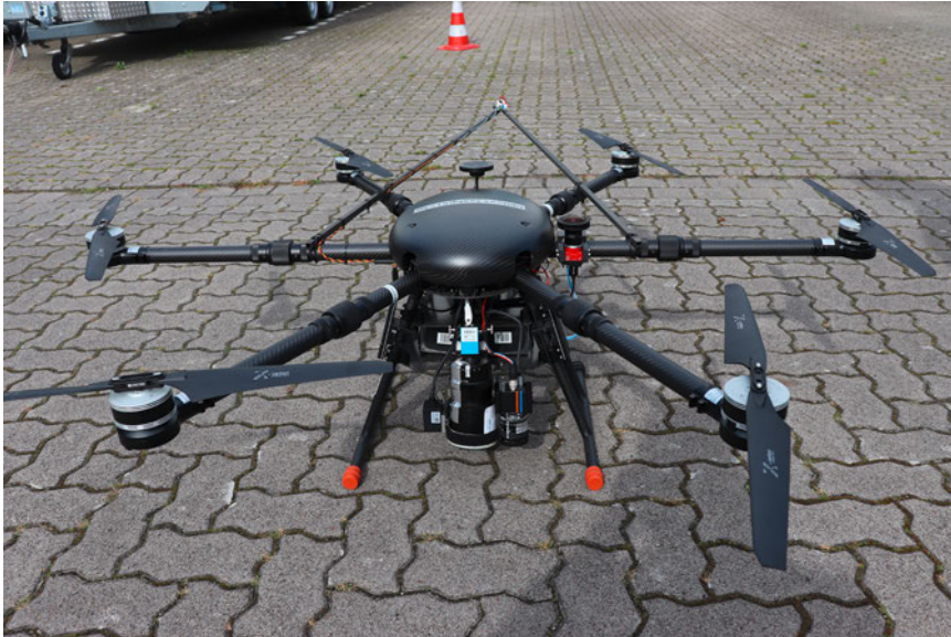
Abb. 1: Hexacopter-Aufbau mit Multispektral- und Polarisationskamera von Optoprecision vor dem Einsatz über der Flachwasserzone
