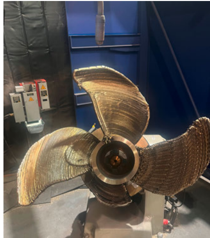
Abb. 3: Erprobung unterschiedlicher Werkzeugbahnen zum Auftragsschweißen in der Versuchsanlage bei der MMG
