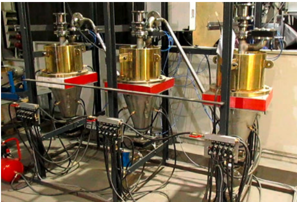
Abb. 4: Im Projekt durch die Mecklenburger Metallguss GmbH entwickelte mehrstufige Siebanlage zur Separation von Schleifspänen nach Partikelgröße
