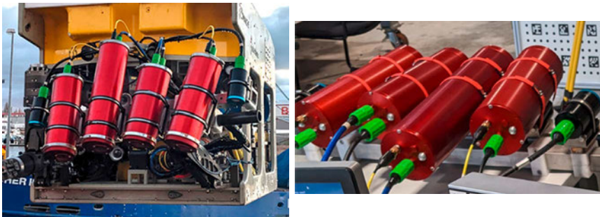
Abb. 2: UWS-Sensorsystem Variante 1 (UWS1) am ROV montiert vor dem Offshore-Einsatz (links) und Variante 2 (UWS2) bei der Luft-Kalibrierung (rechts)
