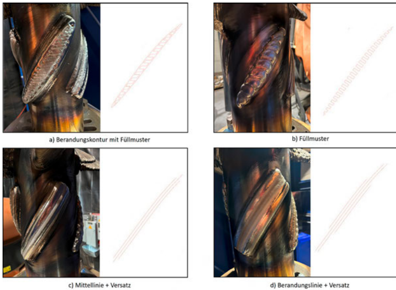
Abb. 5: verschiedene Füllstrategien beim Auftragsschweißen für den Übergang zwischen Propellerflügel und Nabe
