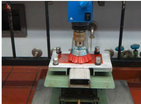
Abb. 4: Hochdruckwasserstrahl- (links) und die Eigenentwicklung eines Bürsten- Laborprüfstandes (rechts) zur Vorqualifizierung der entwickelten Systeme. Die Vorselektion war notwendig, um u. a. die begrenzte Anzahl von Versuchsplätzen im Feld am effektivsten zu nutzen. © Momentive Performance Materials GmbH
