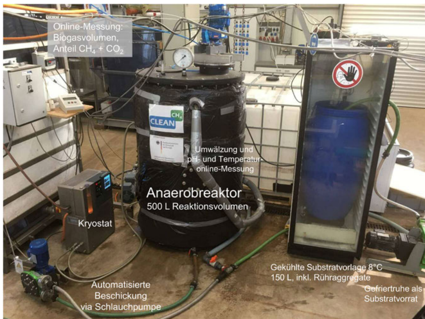
Abb. 4: Halbertechnische CLEAN Versuchsanlage in der Versuchshalle Herrenhausen, Hannover (Quelle: ISAH)
