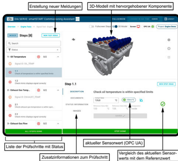
Abb. 8: Durchführungsassistent mit Darstellung der Schritte der aktuellen Inbetriebnahmeprüfung (links), der hervorgehobenen Prüfkomponte im 3D-Modell (rechts oben) und der aktuellen Messwerte über OPC UA (rechts unten) (in Anlehnung an [2])
