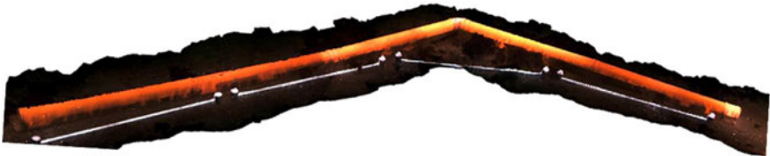
Abb. 10: Tatsächlich realisierte Anordnung des „Rohrleitungssystems“ auf dem Meeresboden (Bild erzeugt aus 3D-Rekonstruktion mittels visueller Odometrie): zur Überprüfung der Maßstabstreue wurden Kugelstäbe der Länge 2 m neben das Rohr gesetzt
