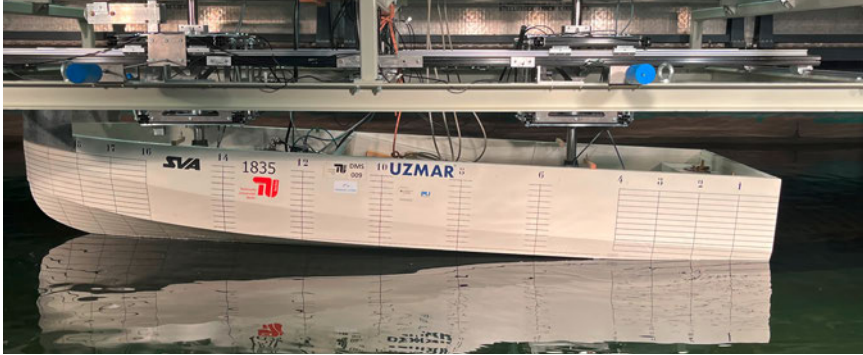
Abb. 9: Gefesseltes Modell in vorgegebener Schwimmlage an der neu entwickelten Messplattform
