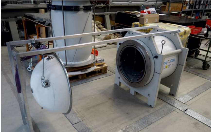
Abb. 9: DeepC3000 im Lander mit Schienensystem im geöffneten Zustand; Bild: M. Hering
