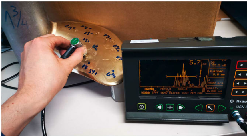
Abb. 11: Ultraschallprüfung des geschliffenen LPA-Propellerblattes
