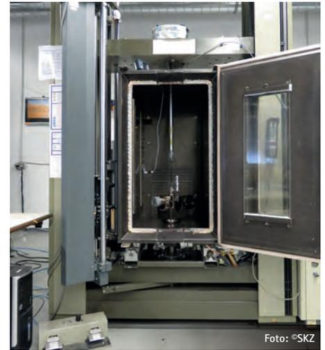
Bild 2: Prüfaufbau – Strain Hardening Test
