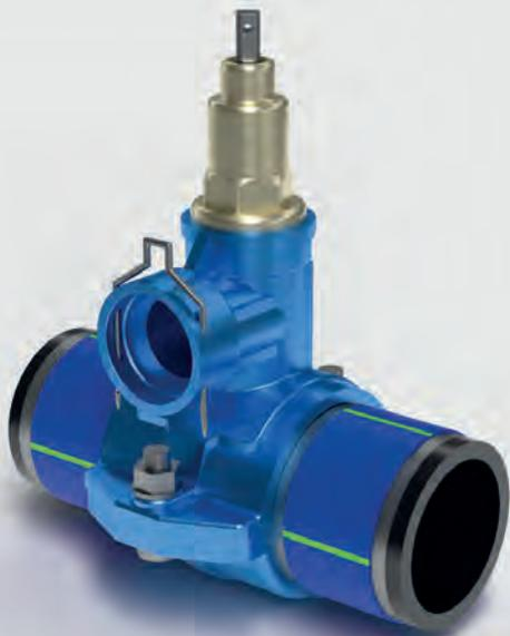
Permeationsdichte Ventilanbohrarmatur für das permeationsdichte Rohrsystem GEROfit® REX mit seitlichem Abgang und integriertem Niro-Anbohrfräser für den Einsatz in kontaminierten Böden
