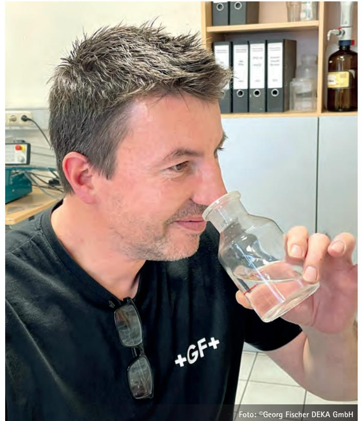
Bild 2: Vorgehen zur Prüfung des TON bei GF DEKA.
