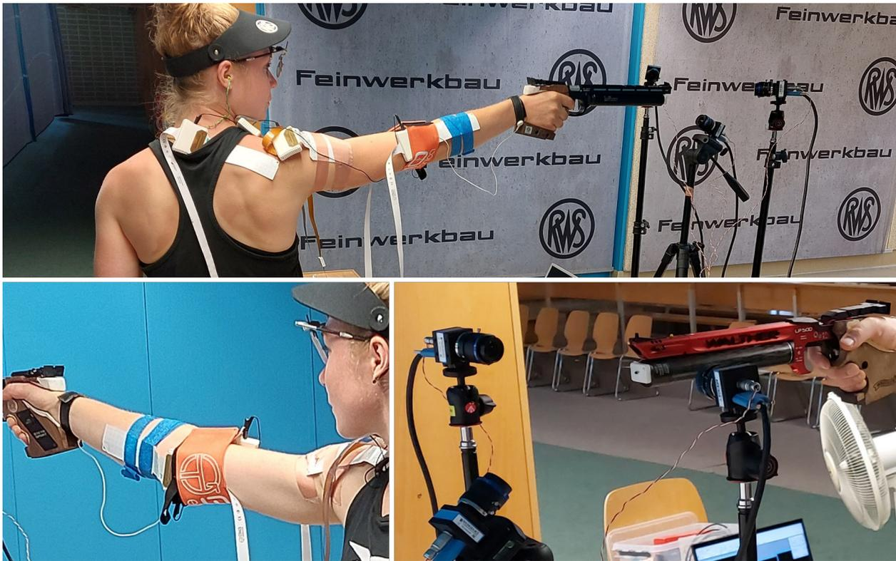
Abb. 1: Experimentelles Setup. Athletin im Anschlag. Oben und unten links: Fünf 64-Kanal-HDEMG-Elektroden auf *m. trapezius*, *m. deltoideus*, *m. flexor digitorum* und *m. extensor carpi radialis*. Oben und unten rechts: Kameramesssystem zur Synchronisierung der Beschleunigungssensordaten und HDEMG-Daten. Unten rechts: Beschleunigungssensor (weiße kleine Box) im Bereich der Mündung angebracht.
