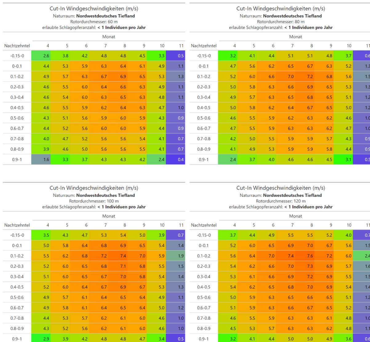
Abb. 18: Cut-In Windgeschwindigkeiten (m/s) für eine erlaubte Schlagopferzahl < 1 Individuum pro Jahr für die Region des Nordwestdeutschen Tieflandes bei WEA mit Rotordurchmessern von 60–120 m.
