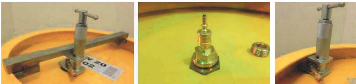
**Abb. 2.25** Prototypen zur Gasentnahme über den Sintermetallfilter: Probennahme mittig (links), Probennahme über großen Druckentlastungsfilter (mittig) und Probennahme unter Winkelring /JEN 19/
