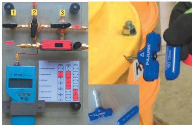
**Abb. 2.24** Schaltbrett für die Verbindung (links), Knochenmarkskanüle zum Durchstechen der Deckeldichtung (rechts) /JEN 19/
