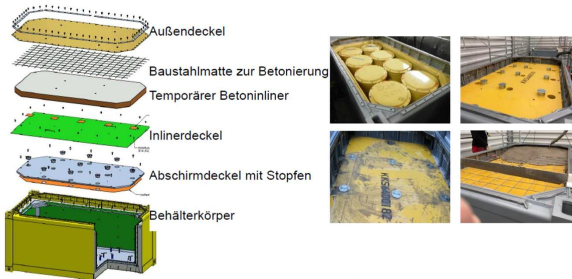
**Abb. 2.23** Schematischer Aufbau der Container (links) und Bilder der Arbeiten (rechts) /GNS 20/
