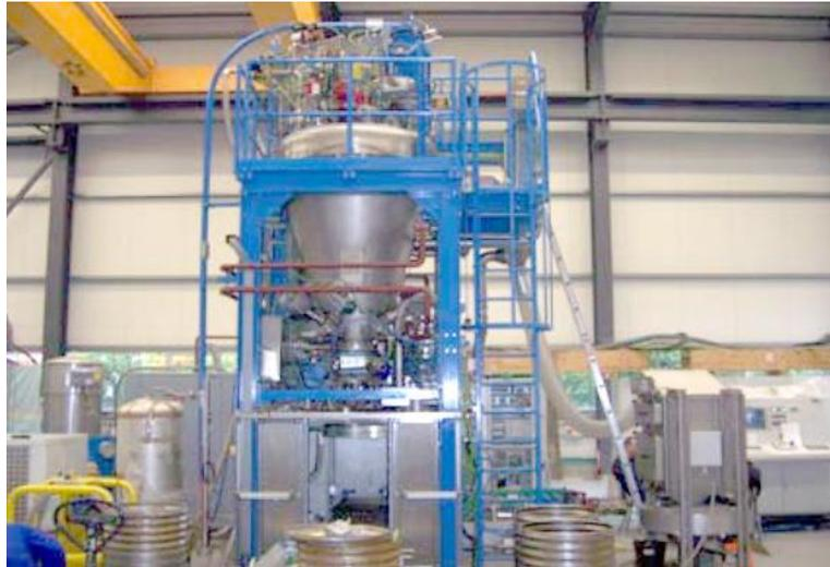
**Abb. 2.9** Anlage zur Trocknung von Ionenaustauscherharzen der Firma Westinghouse /WES 15/
