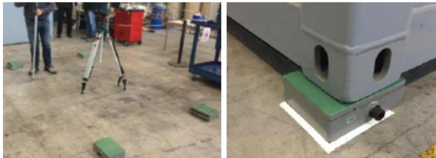
**Abb. 2.20** Einmessen der Aufstellflächen (links), Keilschuhe als einstellbare Aufstellflächen /GNS 20/
