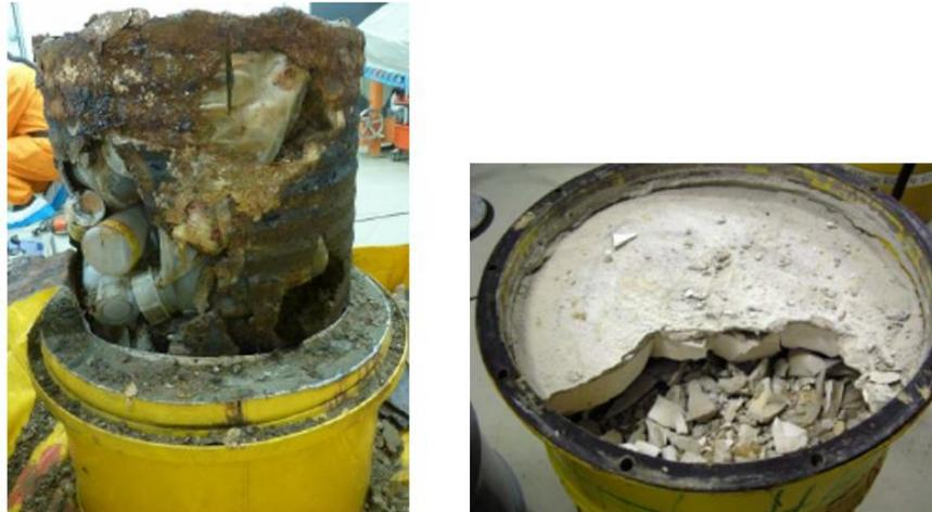
**Abb. 4.9** Zerlegtes Fass mit Papier und Zellstoff (links) und geöffnetes Fass mit Aufbruch der Betondecke gefüllt mit Mischabfall und Thoriumsulfat (rechts) /HAT 20/
