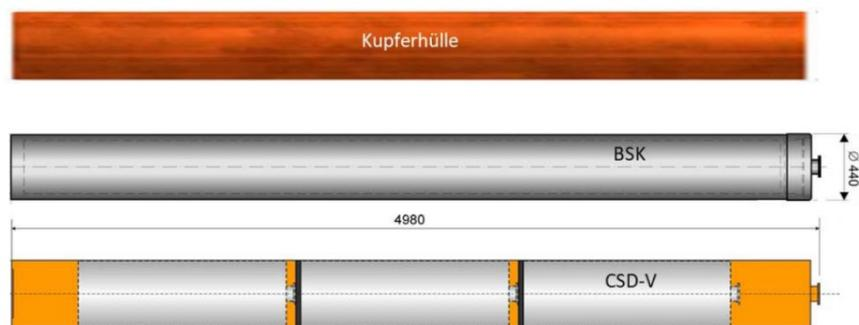
**Abb. 2.1** Brennstabkokille mit Kupferhülle, beladen mit 3 CSD-V /JOB 21/
