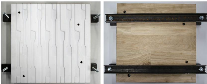
**Bild 3** Gussform aus PTFE zur Herstellung von Prüfkörpern für die Zugversuche mit der Bezeichnung 1A nach DIN EN ISO 527-1.
