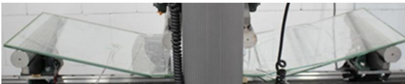
**Bild 83** Vakuum-Isolierglas nach dem Bruch im Vierpunkt-Biegeversuch.
