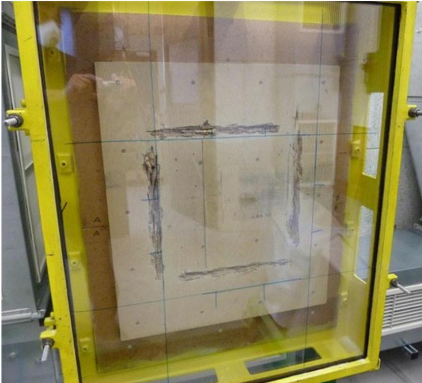
**Bild 64** Prüfkörper im Axtversuch zum Nachweis gegen manuellen Angriff nach DIN EN 356. Die Abmessungen betragen 900 mm auf 1.100 mm.
