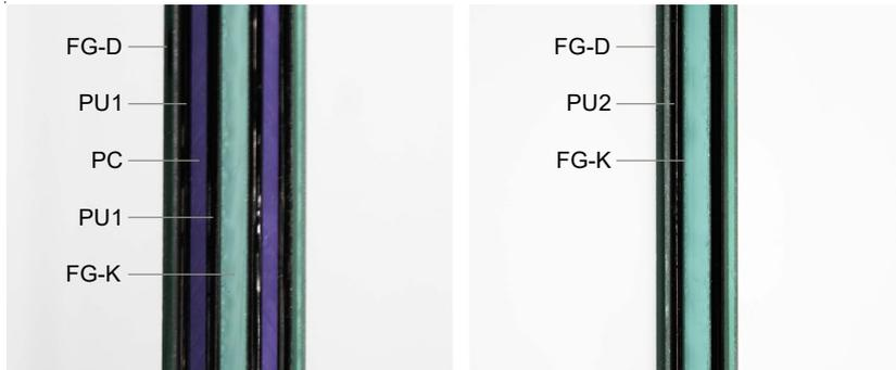
**Bild 5** Querschnitt der zwei Varianten mit Angabe der einzelnen Schichten. Links: Variante 1 mit Glas, Polycarbonat und PU1. Rechts: Variante 2 mit Glas und PU2.
