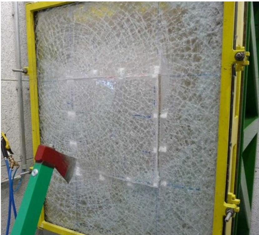
**Bild 66** Prüfkörper nach Durchdringen des ersten Glaspaketes.
