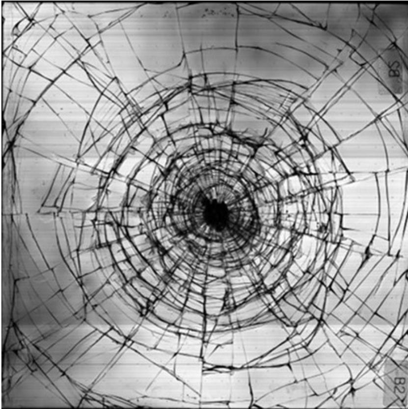
**Bild 27** Aufnahme von Bruchbild des beschädigten Prüfkörpers nach dem Kugelfallversuch.
