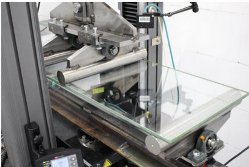
**Bild 73** Versuchsaufbau für den Vierpunkt-Biegeversuch mit Vakuum-Isolierglas.
