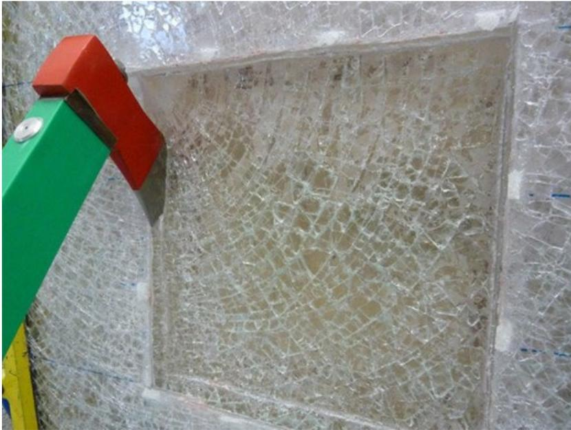
**Bild 67** Prüfkörper beim Einbringen der Öffnung in das erste Glaspaket.
