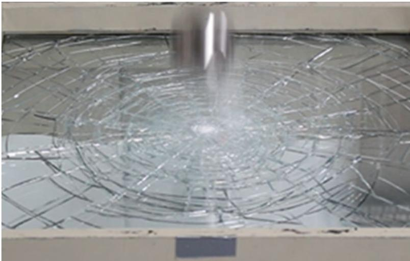
**Bild 25** Stahlkugel im Kugelfallversuch unmittelbar nach dem Aufprall auf die Verglasung.
