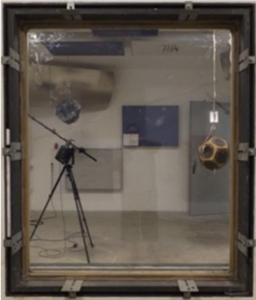
**Bild 68** Im Prüfstand eingebauter Prüfkörper zur Ermittlung des bewerteten Schalldämmmaßes mit Blick vom Empfänger- in den Senderraum.
