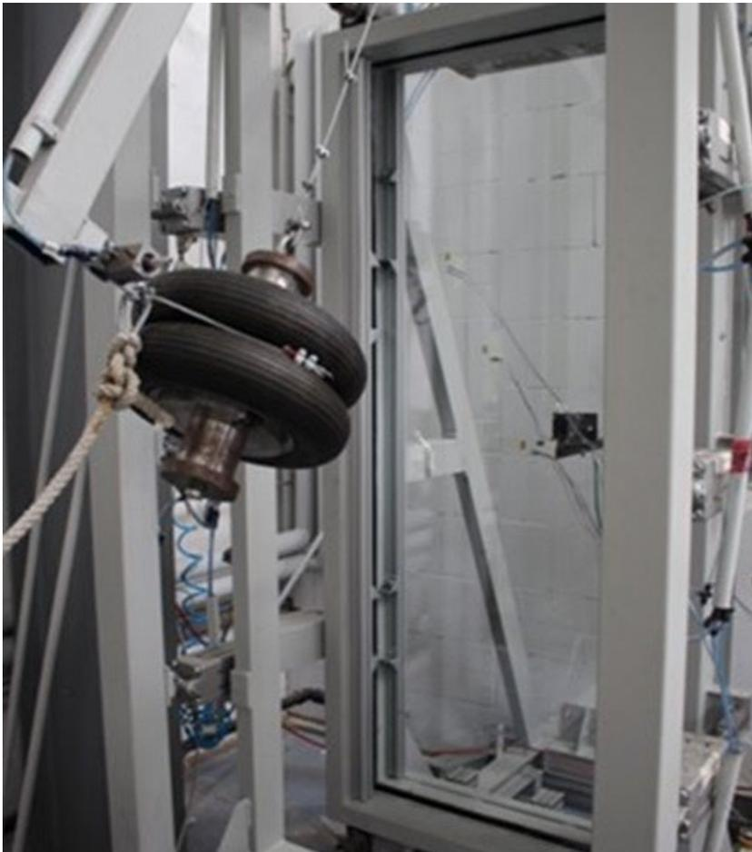
**Bild 46** Pendelschlagversuch mit eingebautem Prüfkörper bei einer Fallhöhe von 450 mm.
