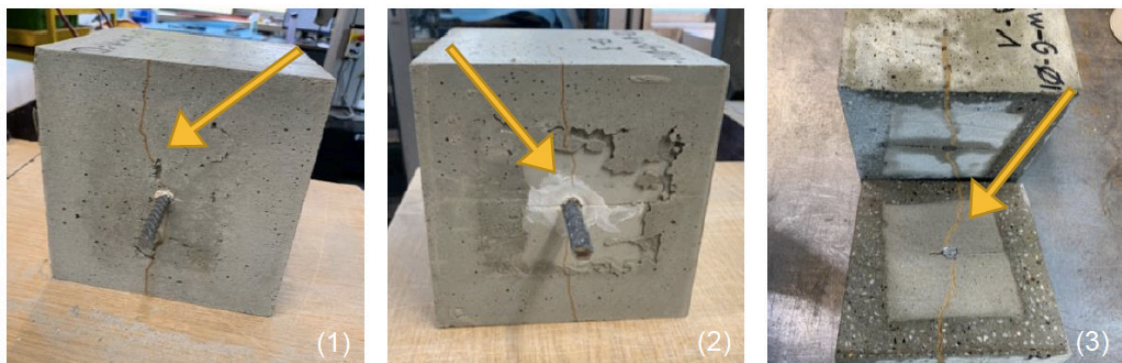
Bild 4.47: Darstellung der Risse anhand der Prüfkörper D_W_w_G_ø10_S9_3 (1), D_W_w_G_ø12_S7_3 (2) und D_W_w_G_ø12_S9_1 (3)
