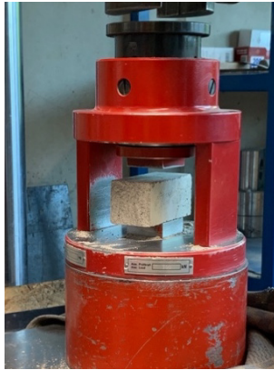
Bild 4.35: (1) Druckprüfmaschine; (2) Formel zur Bestimmung der Druckfestigkeit der halbierten Prismen
