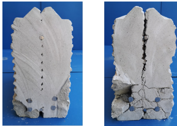
Bild 4.77: Verbundversagen beider Filamente des Prüfkörpers P_S_cTR_cSR400 (1): Schubfeld ohne Schubriss (links); Maßgebendes Schubfeld mit Schubriss (rechts)
