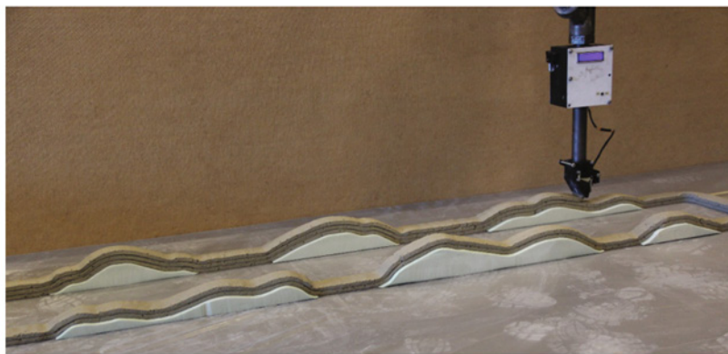
Bild 2.6: Druck auf unebene Druckfläche mithilfe eines Distanzsensors [Wol18a]
