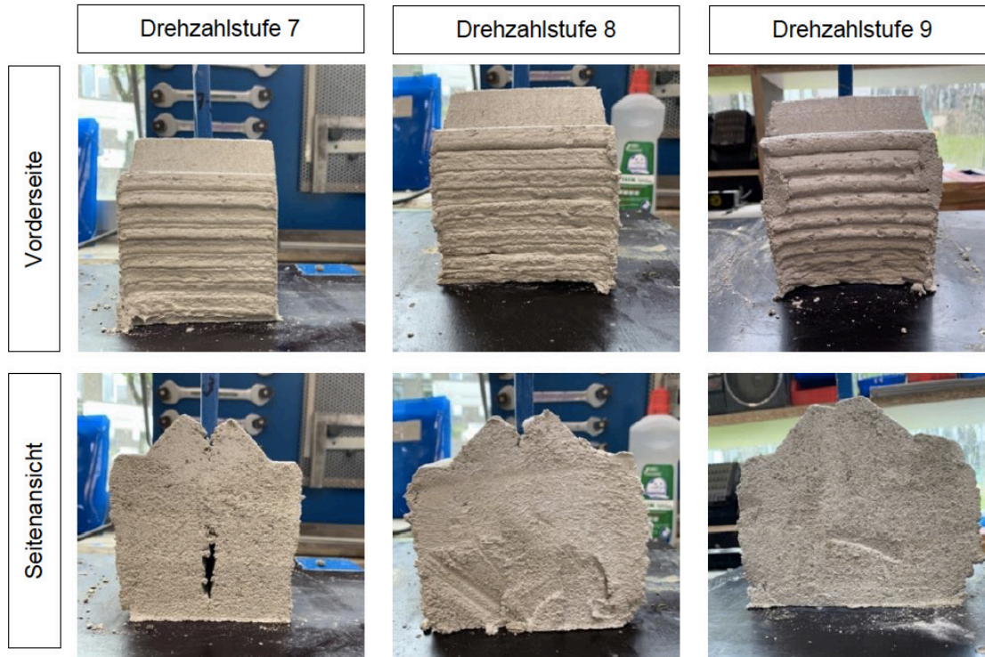
Bild 4.61: Übersicht der gedruckten Prüfkörper mit Bewehrung in w-Richtung bei unterschiedlichen Betonfördermengen
