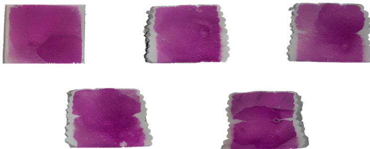
Bild 4.4: Probe mit gesprühtem Phenolphthalein-Indikator [Kal16]
