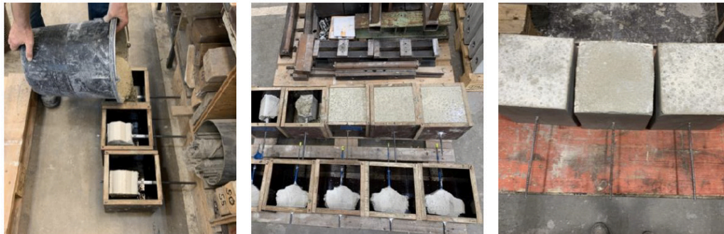
Bild 4.44: Vergussvorgang der 3D-gedruckten Prüfkörper
