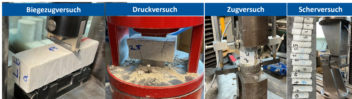
Bild 4.7: Übersicht der Versuchsaufbauten zur Charakterisierung des 3D-gedruckten Betons mit Biegezug-, Druck-, Zug- und Scherversuche
