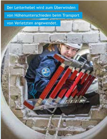
Der Leiterhebel wird zum Überwinden von Höhenunterschieden beim Transport von Verletzten angewendet.
