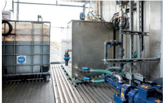
**Halbtechnische Versuchsanlage zur Entschwefelung von Biogas (BioSulfOx).**
