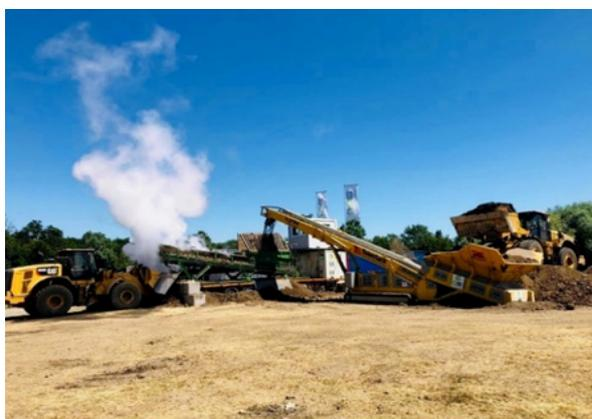
Abb. 15: Mobile Dämpfmaschine, die über eine thermische Behandlungsanlage mit Pflanzenmaterial verunreinigtes Erdreich, z. B. durch den Japan-Knöterich (*Fallopia japonica*), behandelt Foto: DS-Umwelttechnik GmbH
