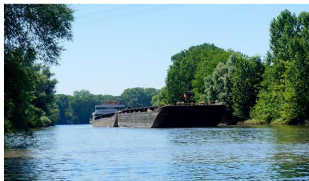
Abb. 20: Binnenschiff im Schifffahrtskanal. Das Schubfahrzeug führt wahrscheinlich Ballastwasser mit, um genügend Tiefgang zur Unterfahrung von Brücken zu haben. Foto: Tina Heger
