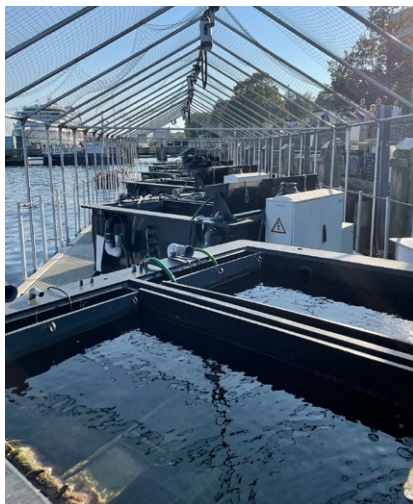
Abbildung 1: Mesokosmen zur Versuchsdurchführung der gezielten Alkalinitätserhöhung zur CO 2 -Aufnahme im Meerwasser mittels Kalkprodukten an der Kieler Förde
