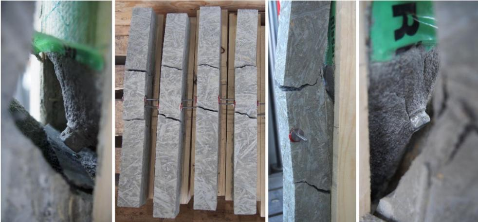
Abbildung 69: Versagensbilder in Serie 5.1 (Kerfen+Schrauben, V1/10) und 5.3 (Kerfen+Schrauben, HFA1-VP)
