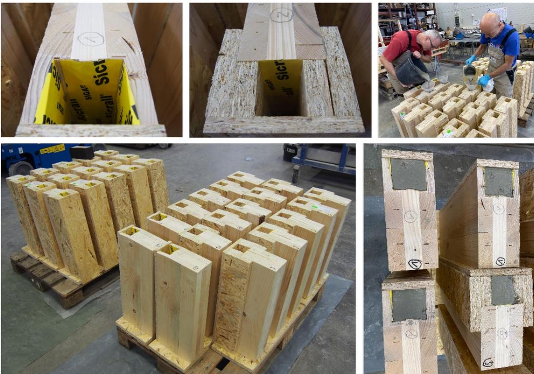
Abbildung 36: Probekörper mit Holzflanken (oben links), ohne Holzflanken mit Spanholzplatten (oben Mitte), Befüllung der Probekörper mit Beton (oben rechts), alle Probekörper (unten links), betonierte Nut (unten links)
