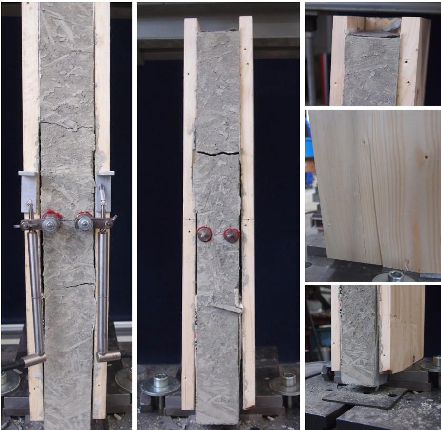
Abbildung 70: Fotos der Probekörper aus Serie 5.2 (Kerfen mit Holzflanken, V1/10) im Bruchzustand
