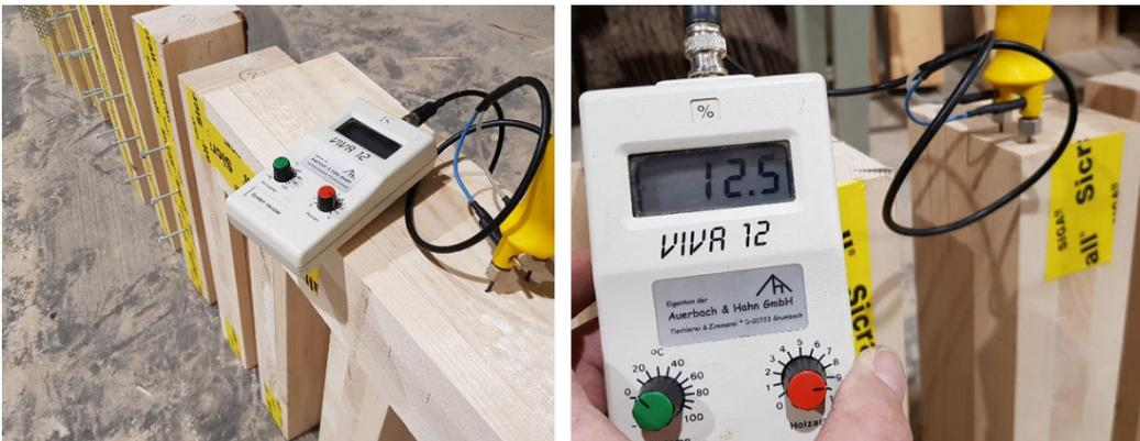
Abbildung 34: Holzfeuchtemessung bei der Herstellung der Probekörper
