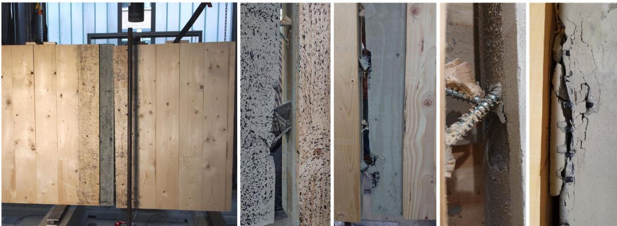
Abbildung 84: Bruchzustand in Serie 3.2 im Versuchsaufbau (links), ausgebauter Probekörper (rechts)
