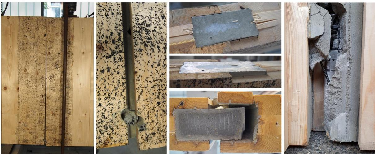
Abbildung 83: Bruchzustand in Serie 3.1 im Versuchsaufbau (links), ausgebauter und aufgestemmter Probekörper (rechts)
