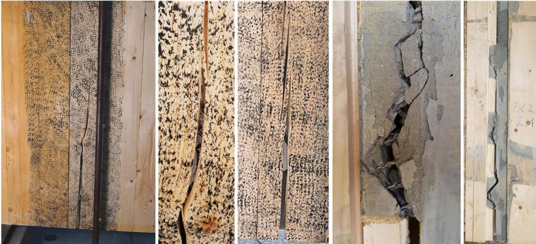
Abbildung 81: Bruchzustand in Serie 2.1 im Versuchsaufbau (links), ausgebaute und aufgestemmte Probekörper (rechts)
