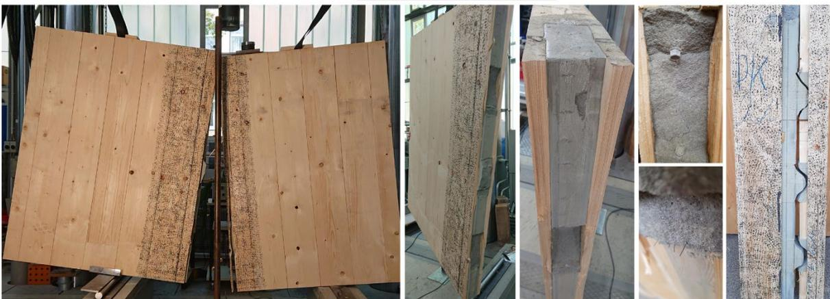
Abbildung 82: Bruchzustand in Serie 2.2 im Versuchsaufbau (links), ausgebauter und aufgestemmter Probekörper (rechts)
