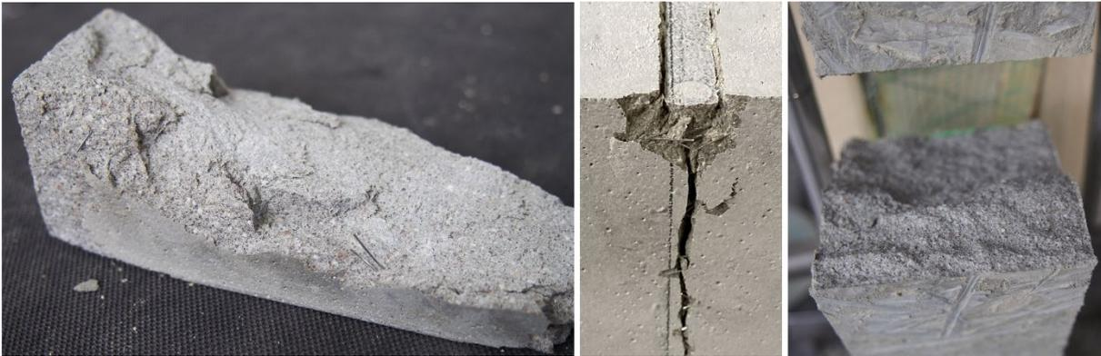
Abbildung 63: Routineversuche zur Überprüfung der Materialeigenschaften des Vergussmörtels „PAGEL HFA1-VP“ am Prisma (links), Spaltzugversuch am Würfel (Mitte) und Druck-Scher-Versuch nach dem Bruch (rechts)
