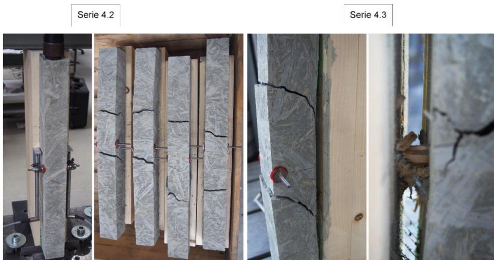
Abbildung 68: Versagensbilder in Serie 4.2 (Schrauben, V1/10) und 4.3 (Schrauben, HFA1-VP)
