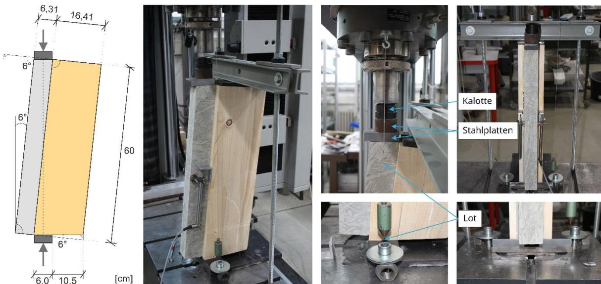
Abbildung 37: Versuchsaufbau als Prinzipskizze (links) sowie Ansicht im Labor in der Prüfmaschine (Mitte und rechts)
