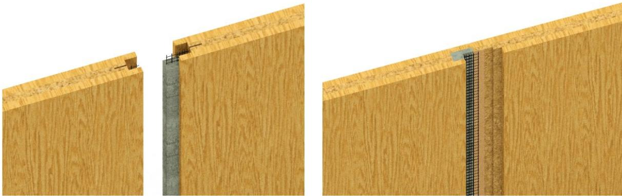
Abbildung 3: Verbindung eines geraden Wandstoßes mithilfe eingeklebter Carbonlegele
