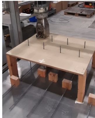
Abbildung 8: Versuchsaufbau zum 3D-Drucken von Stabauszugprobekörpern.
