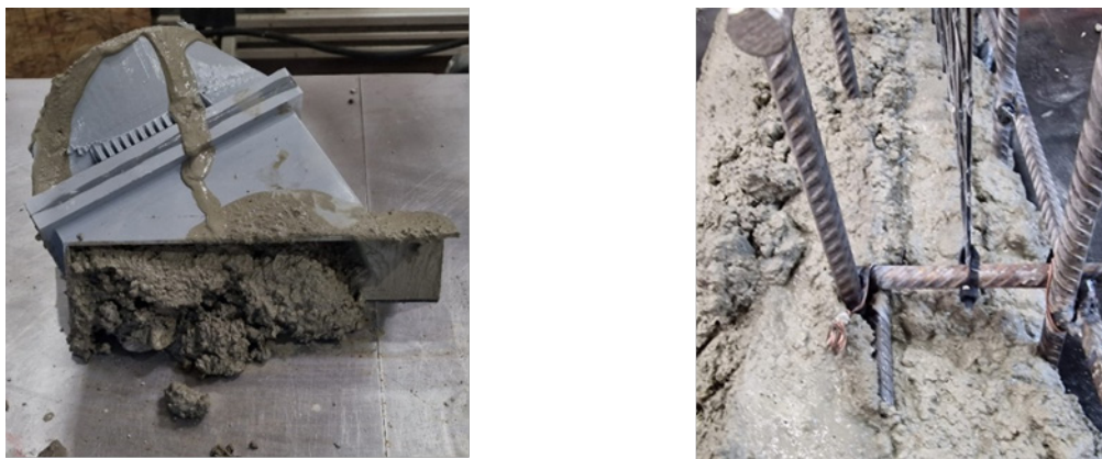
Abbildung 32: Variante 2 - Mehrfache Anstellwinkel der Austrittsöffnung
