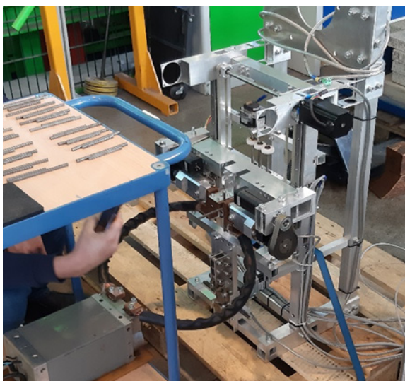
Abbildung 35: Variante 3 - Versuchsaufbau Schweißzange
