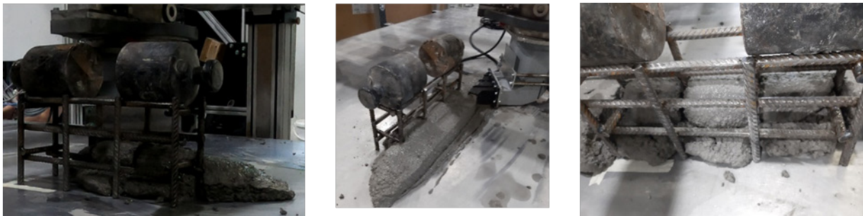
Abbildung 31: Variante 2 - Düsenrichtung horizontal; 60°; Rüttler 50Hz
