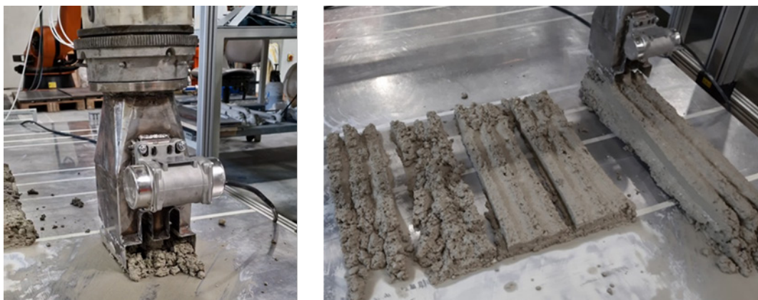
Abbildung 40: Variante 3 - Einsatz eines Rüttler bei verschiedenen Frequenzen
