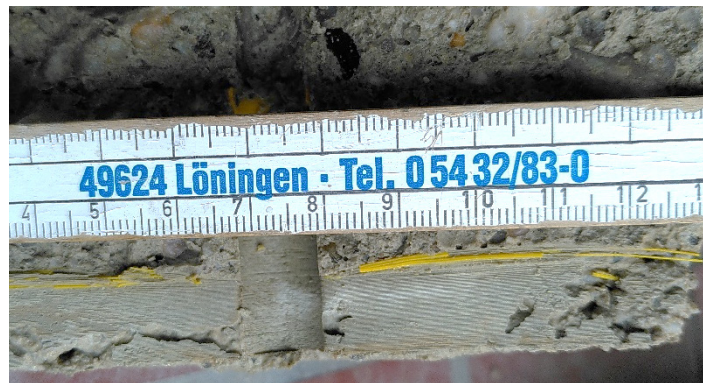
Abbildung 14: Gespaltene Auszugprobe mit Vibration am Stab
