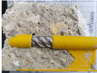
Abbildung 12: Gespaltener Auszugprobekörper mit 3D-gedrucktem Hüllrohr aus Kunststoff
