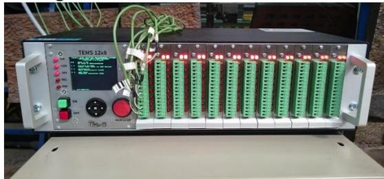
Abbildung 1: Am IW entwickeltes Temperaturmesssystem TEMS 12X8
