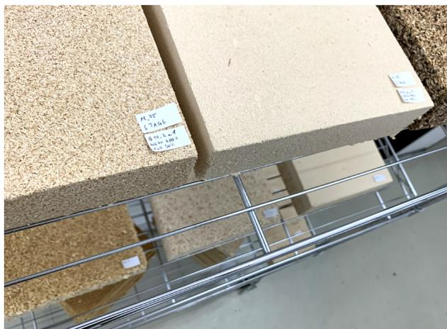
Abb.17: Lagerung von Proben zur Lufttrocknung auf einem Trocknungsregal
