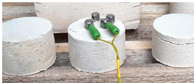
Abb.18: Trocknung und Messung in einer Trocknungskammer nach dem Prinzip des Unternehmens Drywoodboxx
