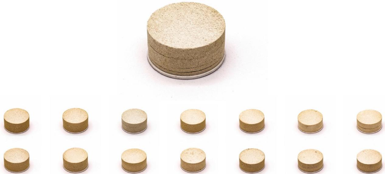
Abb.37: Ausschnitt aus den Forschungsreihen. Bei fast allen Proben ist erkenntlich, dass während des Trocknungsprozesses die Proben in der vertikalen Ausrichtung sich ausdehnen und zu Rissen führt
