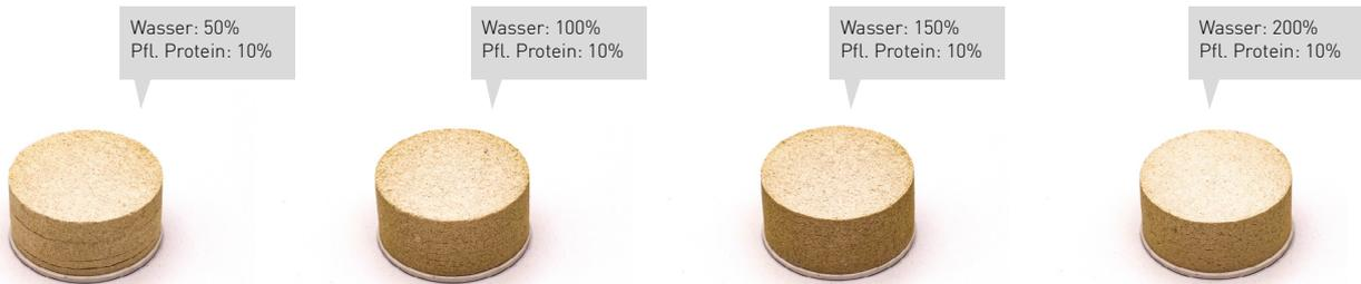
Abb.39: Rezeptentwicklung unter Verwendung von Gluten als Bindemittel. Variierender Wasseranteil (von links nach rechts aufsteigend) bei gleichbleibenden Formstoff- und Binderanteilen. a.) 50 % Wasseranteil, b.) 100 % Wasseranteil, c.) 150 % Wasseranteil, d.) 200 % Wasseranteil
