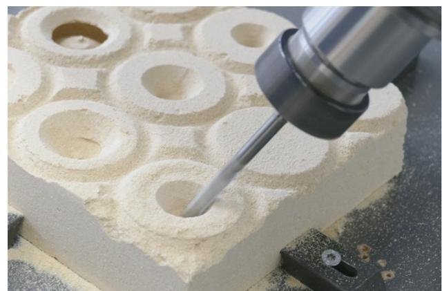
Abb.59: Detaillierung auf feinen Partikeln  $400 \text{ kg/m}^3$  nach Wasserreduzierung, Oberflächenspuren werden mit Fräser 5 und Hohlräume mit Fräser 2 hergestellt
