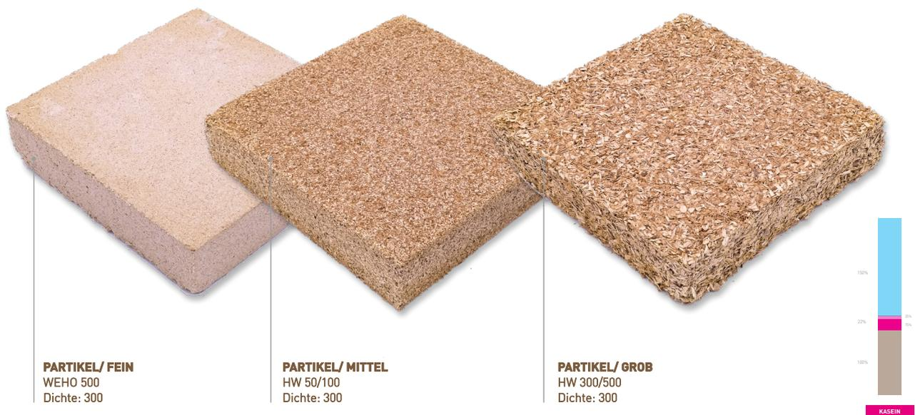
Abb.33: Mit Kasein gefertigte 20 x 20 x 5 cm Akustikelemente. Von links nach rechts der Fasergröße aufsteigend von Holzmehl bis zu Fasern
