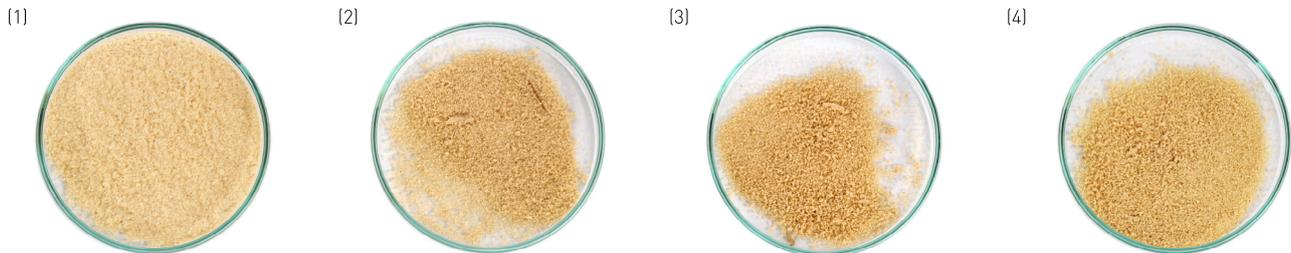
Abb.83: (1) Span im Ausgangszustand (WEHO 500) (2) Rückführung mit Schredder-Werkzeug A (3) Schredder-Werkzeug B (4) Schredder-Werkzeug C
