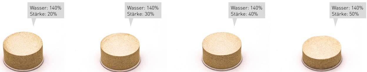
Abb.26: Rohrprobentests. Steigerung des Binderanteils von 20% bis 50% bei gleichbleibenden Wasseranteil von 140%
