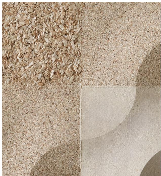
Abb.116: Detailaufnahme eines Panels mit den drei Holzpartikeln sichtbar
