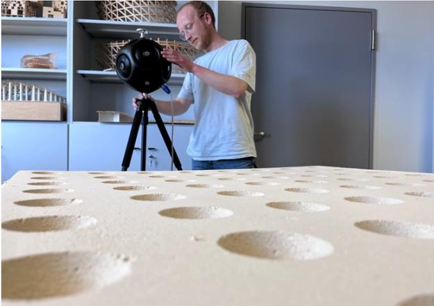
Abb.98: Schallquelle in Form eines Dodekaeders
