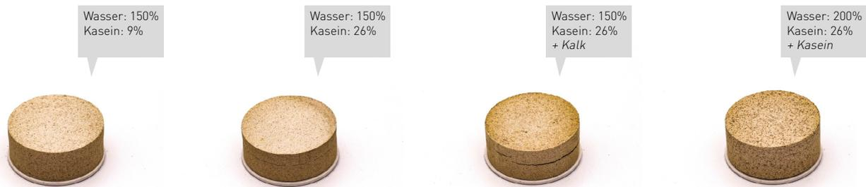
Abb.32: Rohrprobentest. Proben 1 + 2 (von links) wurde der Binderanteil erhöht bei gleichbleibender Leimzusammensetzung. Probe 3 + 4 (von links) bei gleichbleibenden Binderanteil aber mit unterschiedlichen Gewichtungen in der Leimzusammensetzung (Verhältnis Binder zu Kalk)
