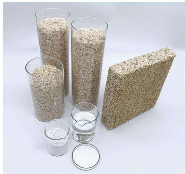
Abb.29: Zur Herstellung eines 20x20x5cm Holzpartikel-Werkstücks benötigte Ingredienzien in Masseanteilen dargestellt a.) Holzpartikel b.) Wasser c.) Stärke d.) Calciumpropionat
