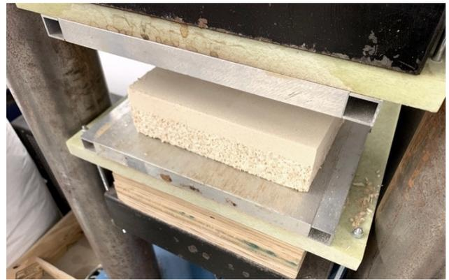
Abb.16: Vorkompaktiertes Holzverbundelement auf Heißpresse
