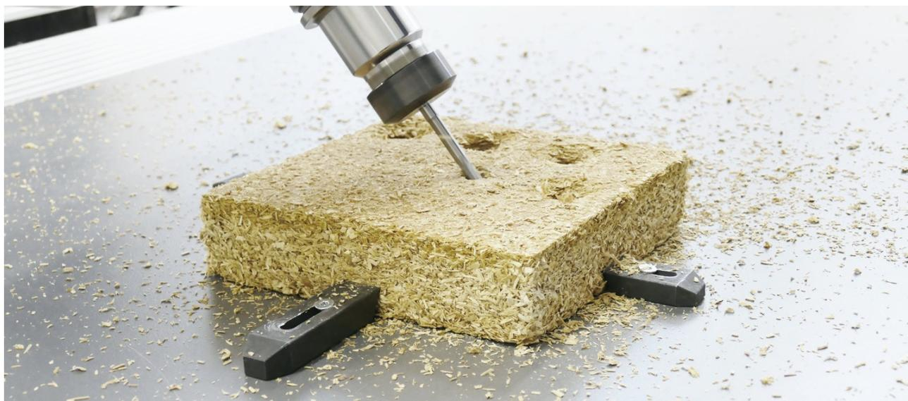
Abb.57: Eingespanntes Akustikelement zur weiteren akustischen Optimierung durch Einbringen von Hohlräumen via subtraktiver Bearbeitung
