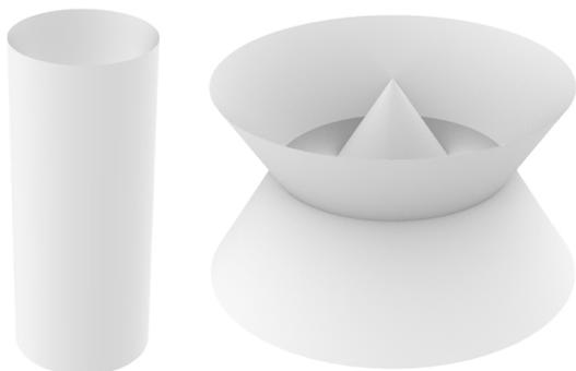
Abb.93: Resonatoren-Typen. Links Typ „Perforation“, rechts „Invertierte Pyramide“.
