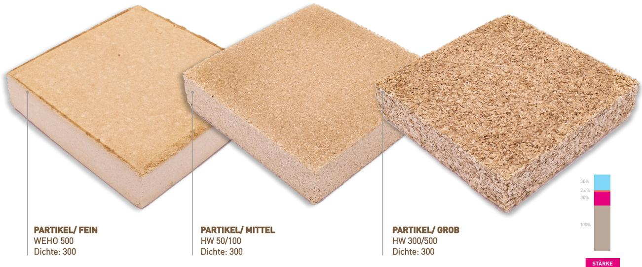
Abb.28: Gefertigte 20 x 20 x 5 cm Akustikelemente. Von links nach rechts der Fasergröße aufsteigend von Holzmehl bis zu Fasern
