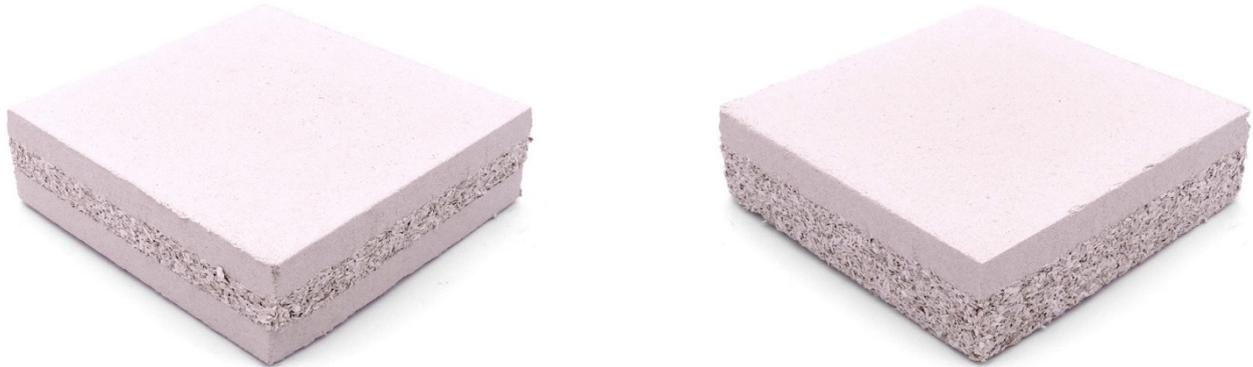
Abb.49: Links: Sandwichelement bestehend aus zwei Deckschicht aus Holzmehl und einem Kern aus Holzfasern. Rechts: Faserverbundelement aus einer Deckschicht aus Holzmehl und einem Unterbau aus Holzfasern
