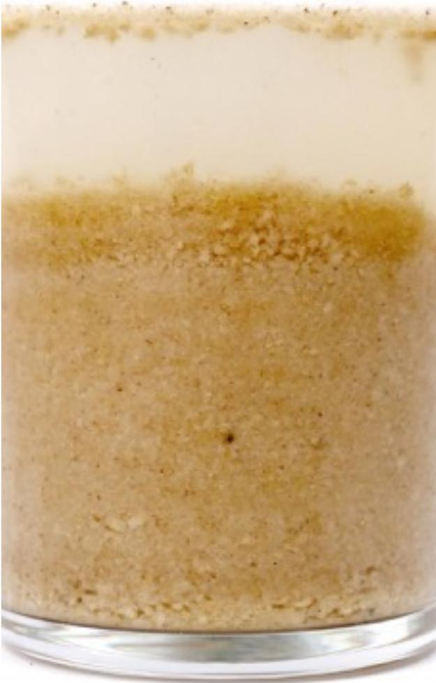
Abb.85: Rückführung von gebundenen Elementen im Wasserbad. Zu sehen ist, dass sich die Binder an der Wasseroberfläche absetzen. Diese können abgeschöpft werden und das noch feuchte Holz erneut gepresst und in den Produktionszyklus zur Herstellung von Akustikelementen eingehen
