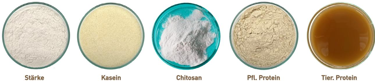
Abb.14: In die Forschungsarbeiten eingebundene Bindemittel in ihrem Ursprungszustand
