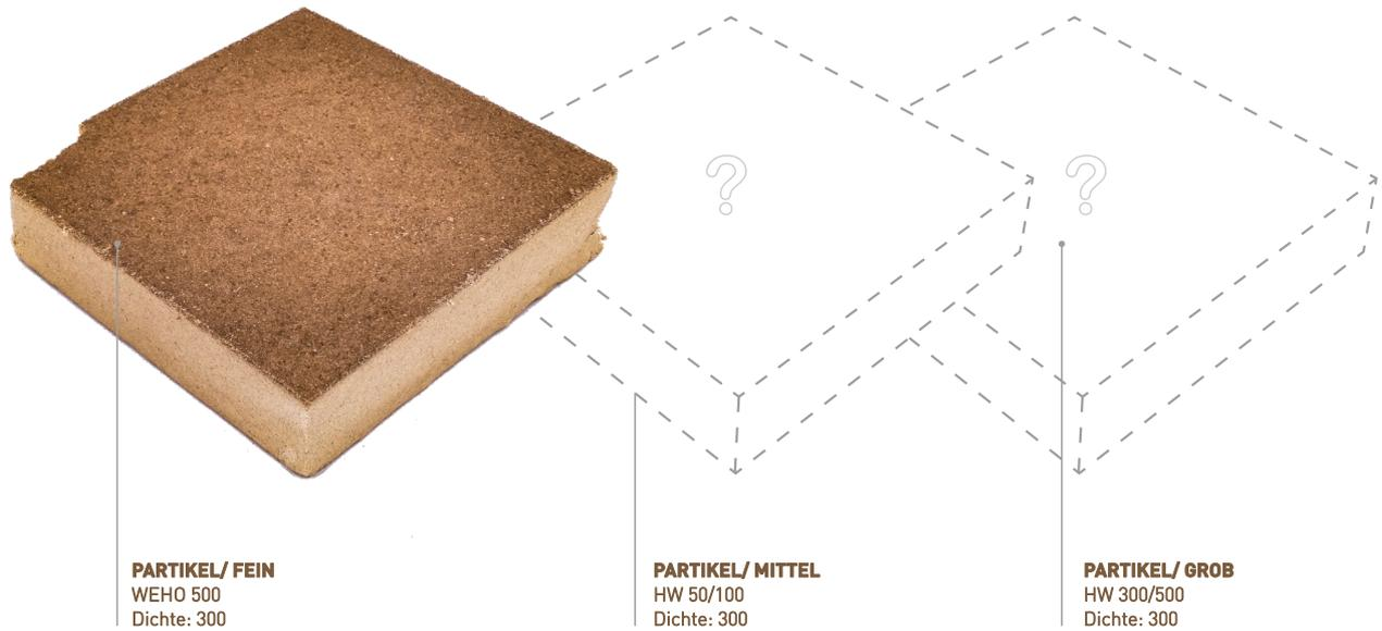
Abb.40: Gefertigte 20 x 20 x 5 cm Akustikelemente. Von links nach rechts der Fasergröße aufsteigend von Holzmehl bis zu Fasern. Ab Fasergrößen von ~ 180 µm können keine Proben realisiert werden
