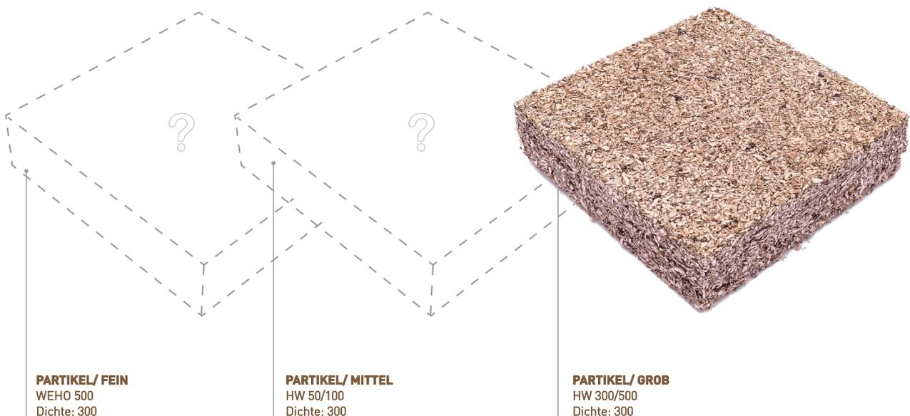
Abb.42: Gefertigte 20 x 20 x 5 cm Akustikelemente. Von links nach rechts der Fasergröße aufsteigend von Holzmehl bis zu Fasern. Erst ab einer Fasergröße von ~ 1000 µm konnten Proben realisiert werden
