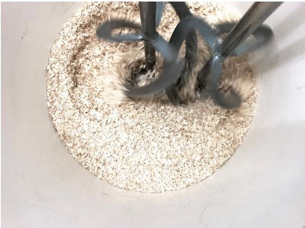
Abb.15: Durchmischung einer trockenen Holzfaser-Binder Rezeptur
