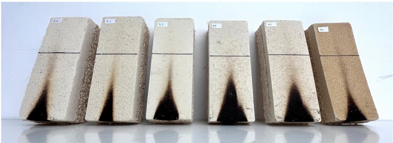
Abb.72: Ergebnisse der Prüfung nach DIN 4102-1 im Vergleich. Von links nach rechts aufsteigend B1 – B6
