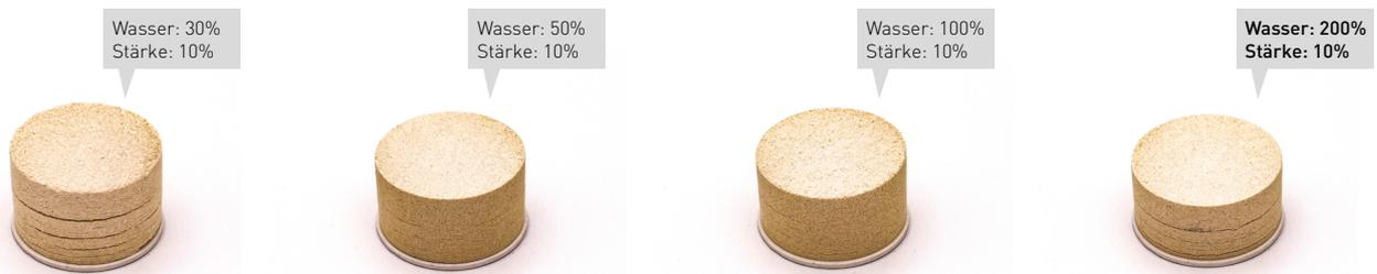
Abb.25: Rohrprobentests. Steigerung des Wasseranteils von 30% bis 200% bei gleichbleibenden Binderanteil von 10%
