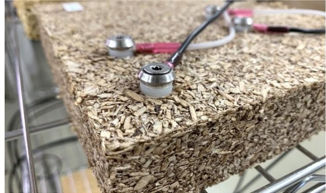
Abb.81: Messung des elektrischen Widerstands im Material durch Elektroden. Dauerhafte Feuchtemessung in Intervallen möglich
