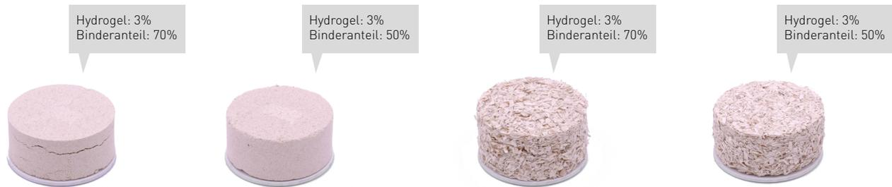
Abb.46: Evolutionärer Entwicklungsprozess von Rezepturerprobungen. Holzmehl und Holzpartikel werden mit unterschiedlichen Anteilen an Binder versehen bei gleichbleibenden Hydrogel Anteil
