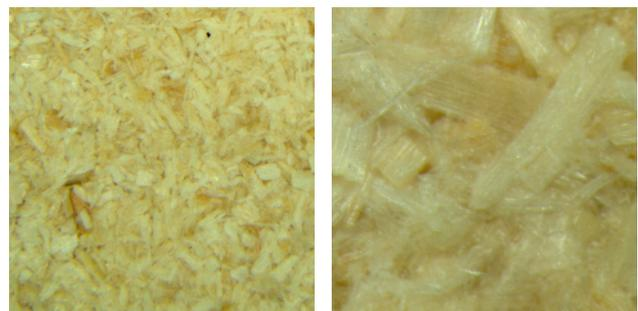
Abb.12: Mit Stärke verkleisterte Holzfasern. Vergrößerung der Oberflächen (0,6-fach und 6,6-fach)
