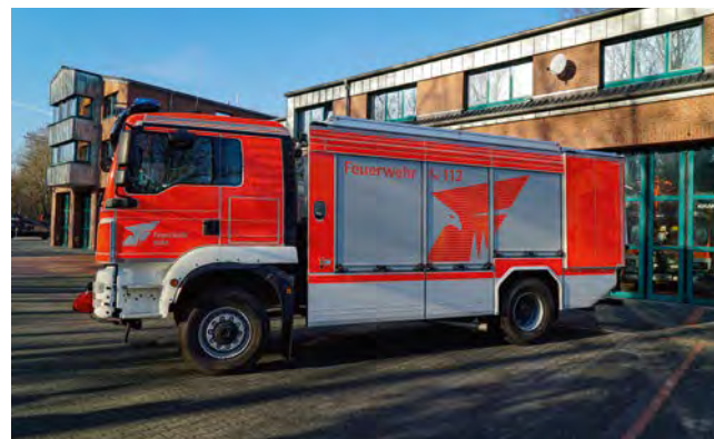
Der Rüstwagen verfügt über ein Be- und Entlüftungsgerät zur Entrauchung von geschlossenen Räumen.
