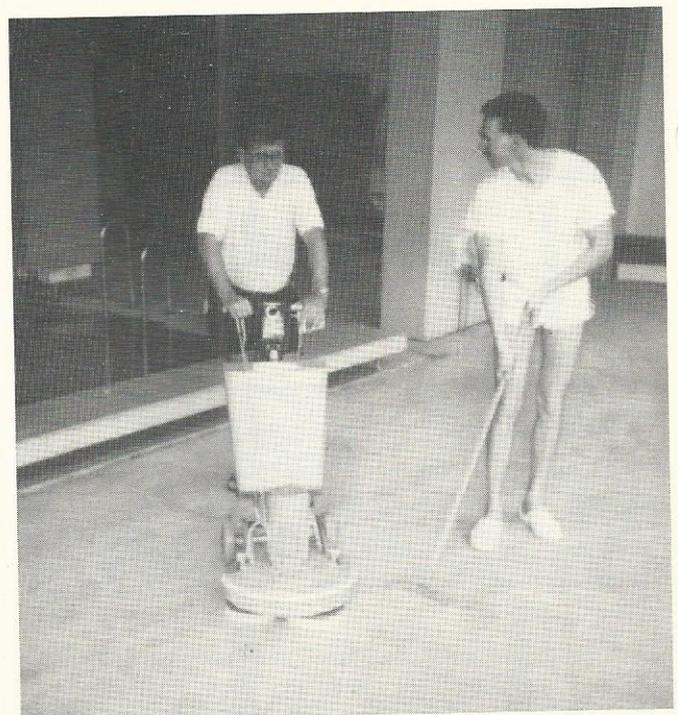
Mechanische Reinigung; hier demonstriert auf die alte Weise (rechts) und mit der neuen **3-Scheiben-Scheuermaschine** (links)
