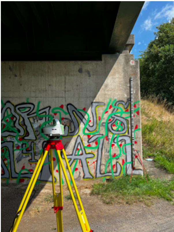
Das Nivellier und die Nivellierlatte
