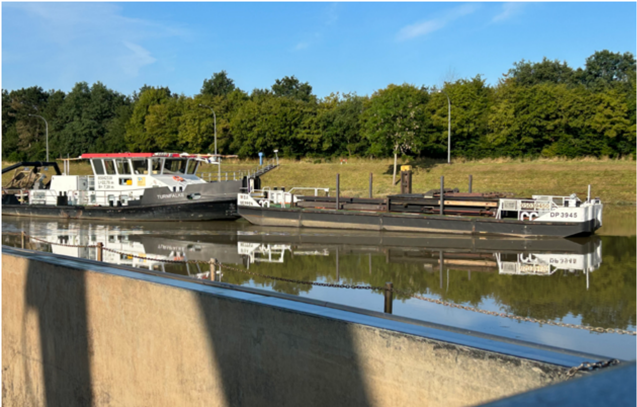
Koppelverband über Koppelwinden: TURMFALKE (Mehrzweckschiff mit Eisbrechereigenschaften) und Deckprahm (DP)
