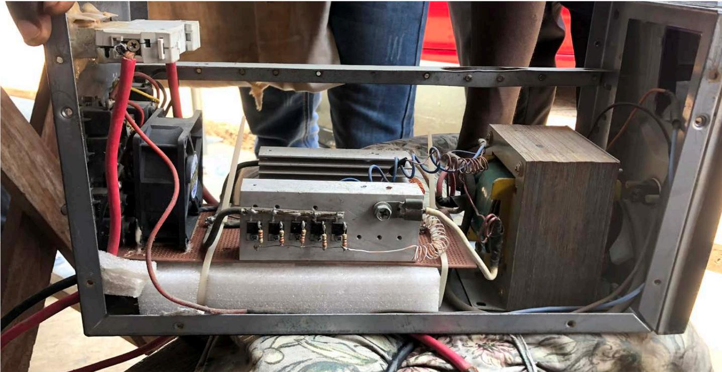
Figure 15 : Un onduleur construit par un maître et ses apprentis pour une installation solaire, Accra
