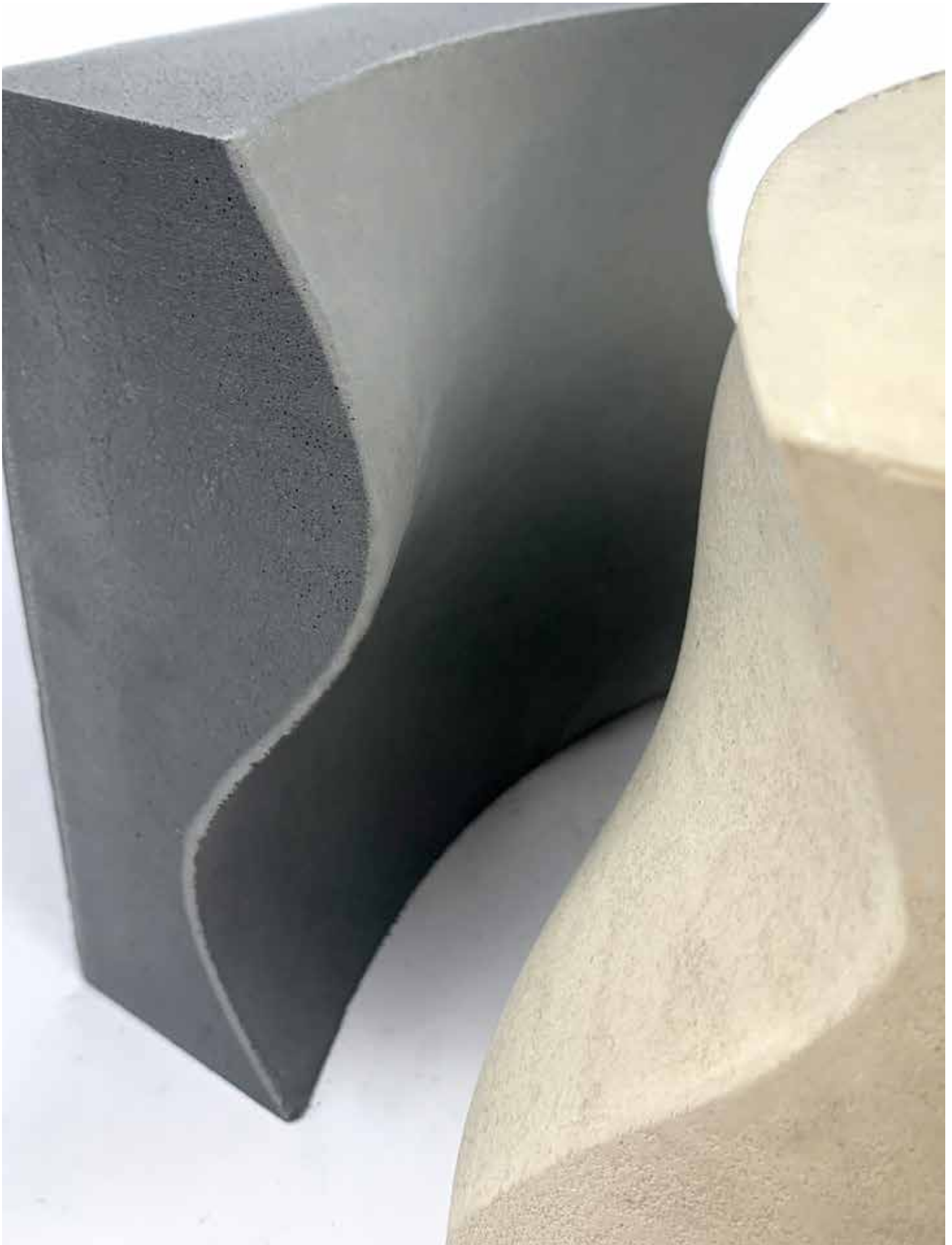
Abb. 186: Sandschalung und resultierendes Betonelement
