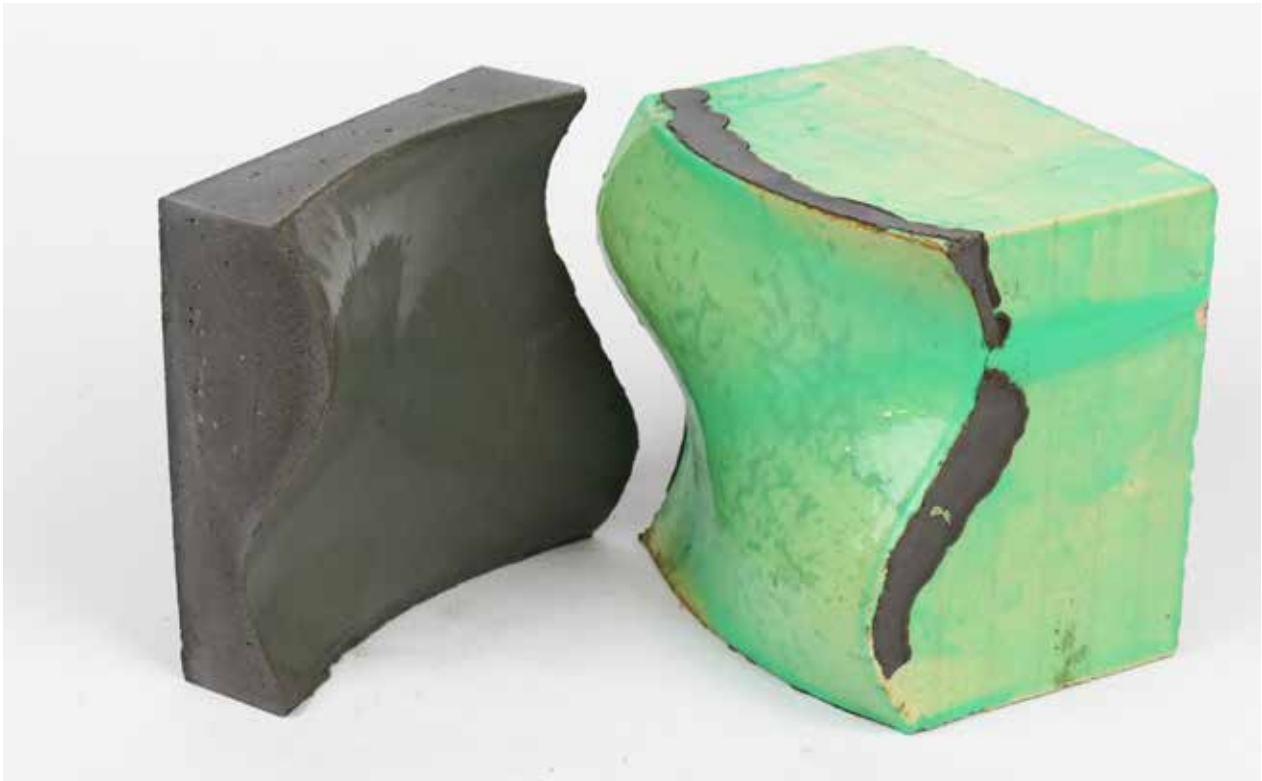
Abb. 68: Betonabguss und Schalung mit Silikon Versiegelung
