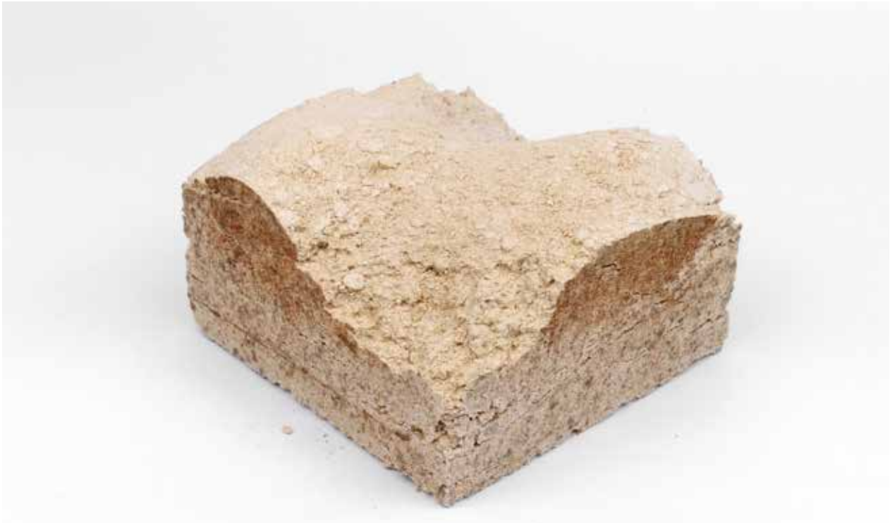
Abb. 51: Holzspan-Stärke-Schalung: erste Fräsversuche
