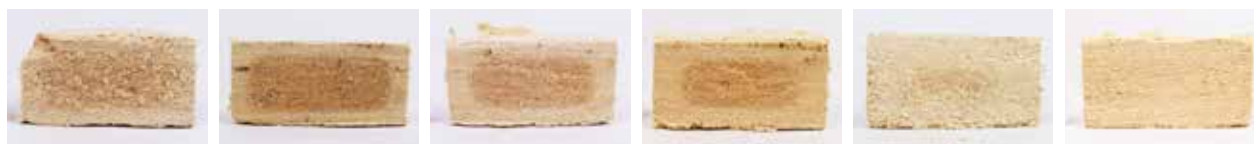
Abb. 27: Trocknungsverhalten von Holzspan-Stärke bei Lufttrocknung. Von Links: (1.) 2 Tage (2.) 3 Tage (3.) 4 Tage (4.) 5 Tage (5.) 8 Tage (6.) 10 Tage
