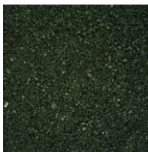
Abb. 6: Formsand / 0,6-fache Vergrößerung
