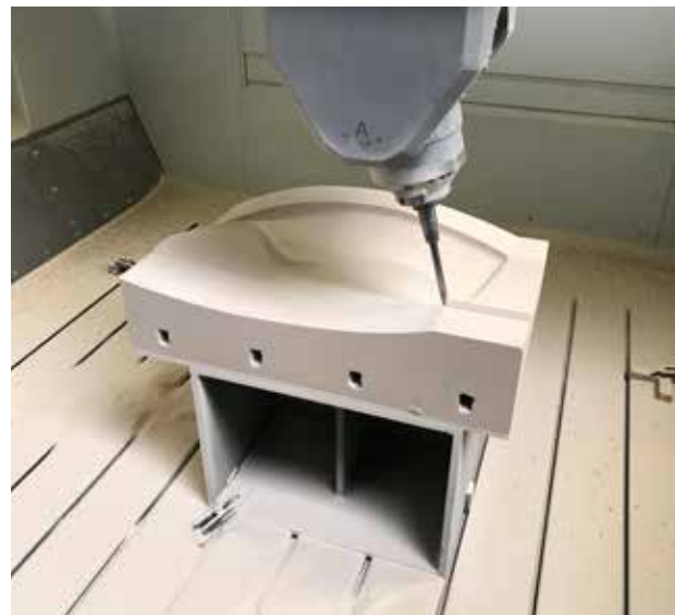
Abb. 44: Subtraktive Bearbeitung von Keramiksand „Maus Modellbau GmbH“
