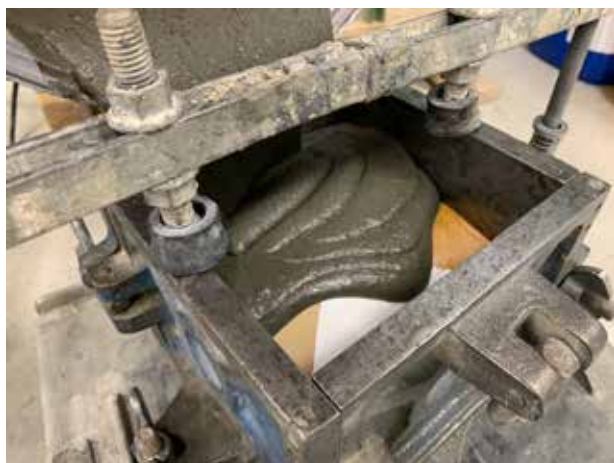
Abb. 56: Betonage eines geformten Schalungskörpers in 150 x 150 mm Stahlschalung
