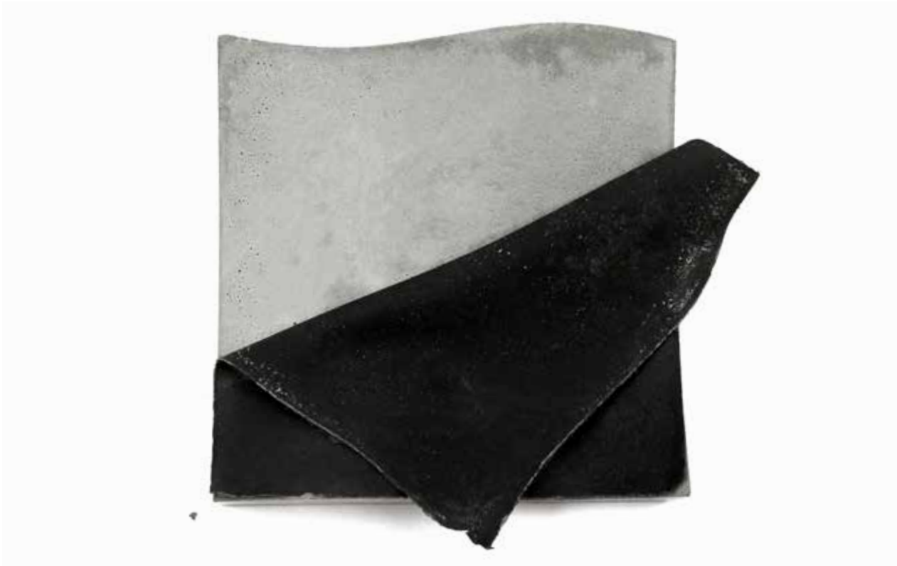
Abb. 66: Ausschalen Betonabguss / Latex Versiegelung
