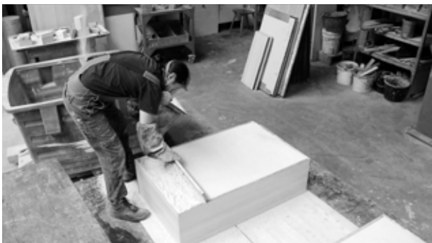
Abb. 108: Herstellung des Schalungsrohlings aus Keramiksand
