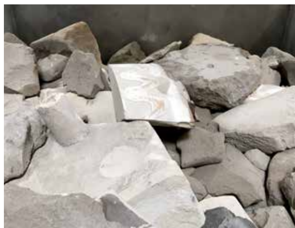
Abb. 93: Mechanische Regeneration von Keramiksand im Sandbrecher
