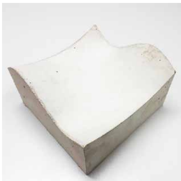
Abb. 100: Abguss Trennmittel „SOK Aqua“ (Elo Beton)
