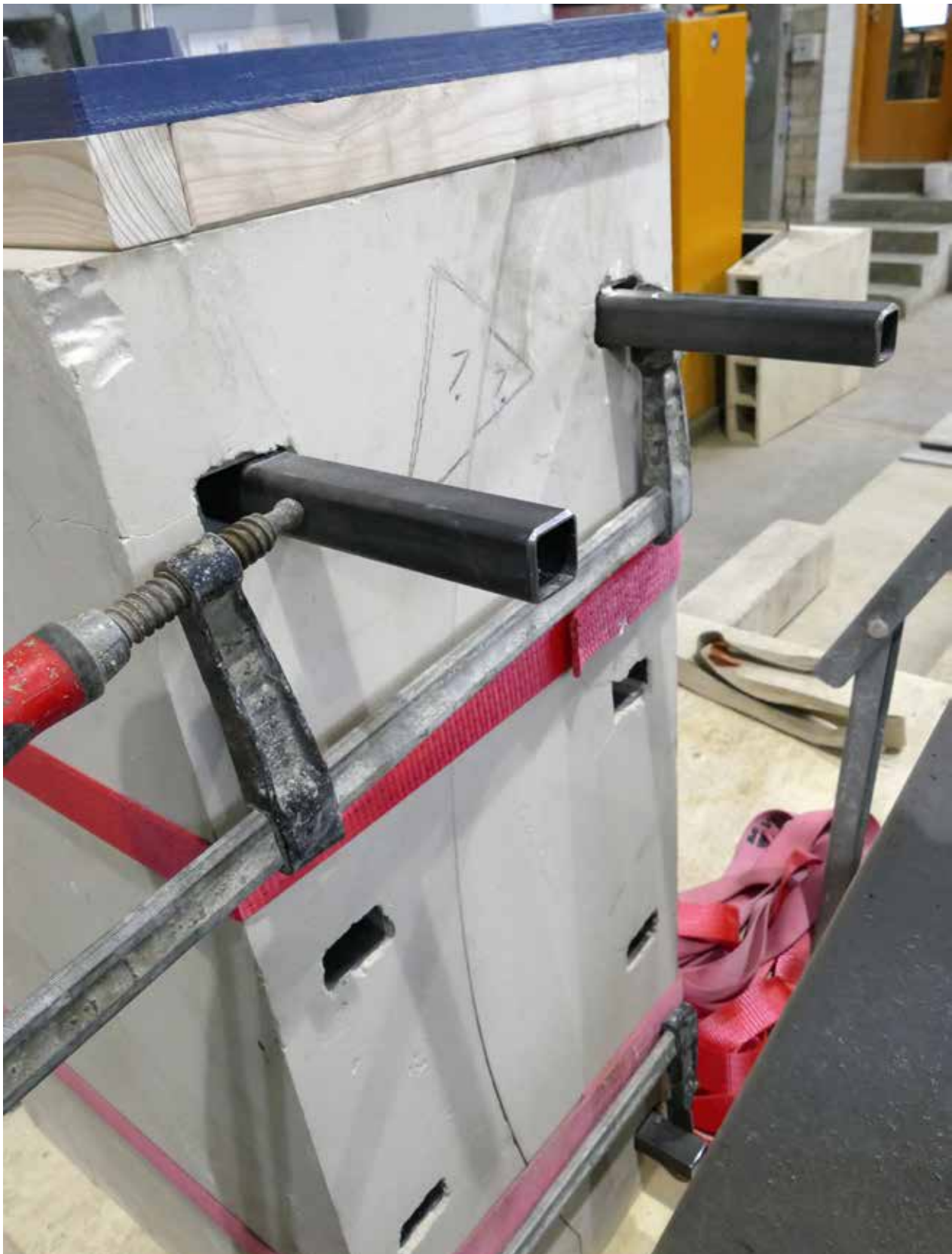
Abb. 124: Bewehrungselemente als Anführungspunkte für Krananlagen (ELO)
