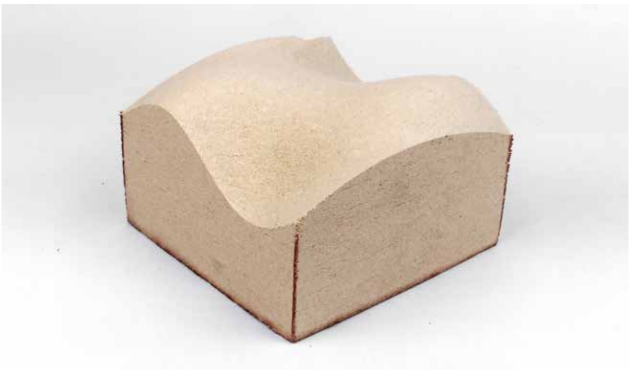
Abb. 52: Holzspan-Stärke-Schalung: Ergebnis nach Rezeptur- und Fräsoptimierung
