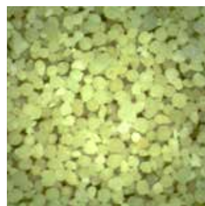
Abb. 11: Cerabeads 1700 / 6,6-fache Vergrößerung
