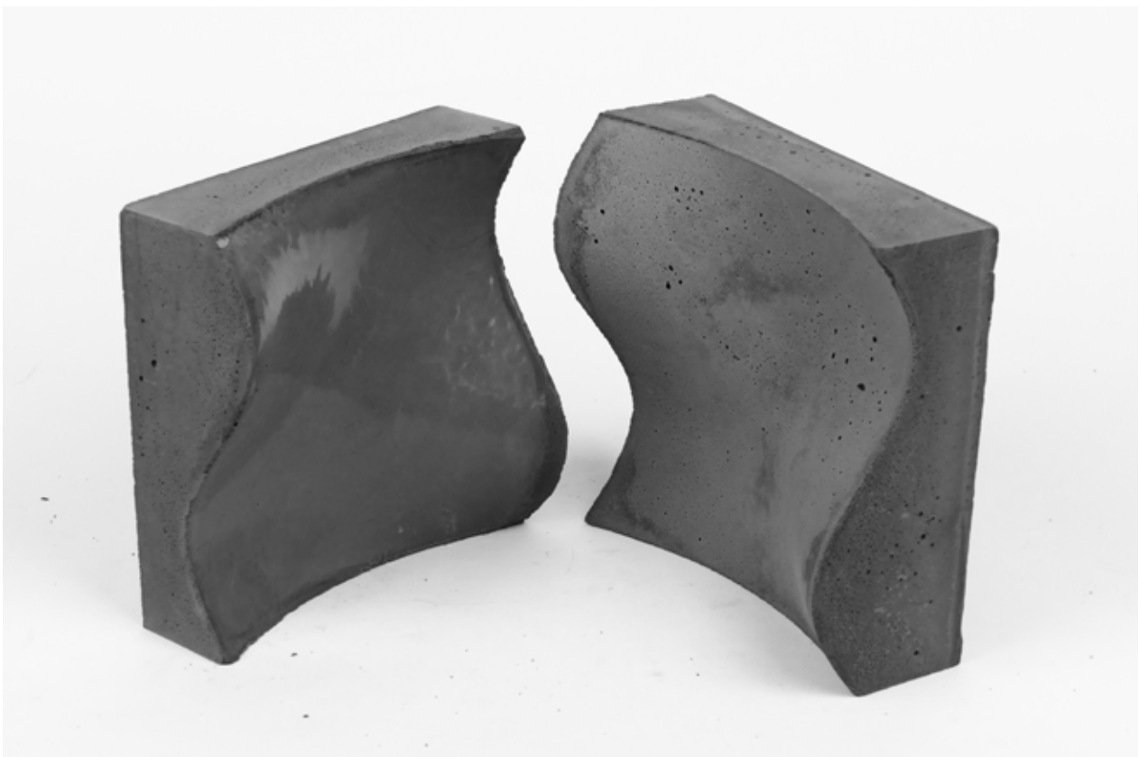
Abb. 69: Vergleich von Betonabgüssen. Links: Silikon-Beschichtung, Rechts: Latex-Beschichtung
