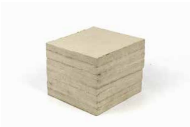
Abb. 39: Schichtung von Holzspan-Stärke-Lage (150 x 150 x 20 mm)
