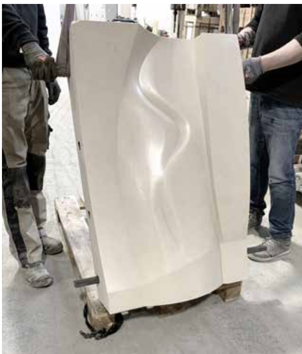
Abb. 118: Mit Trennmittel versehenes Schalungselement (Runkel)
