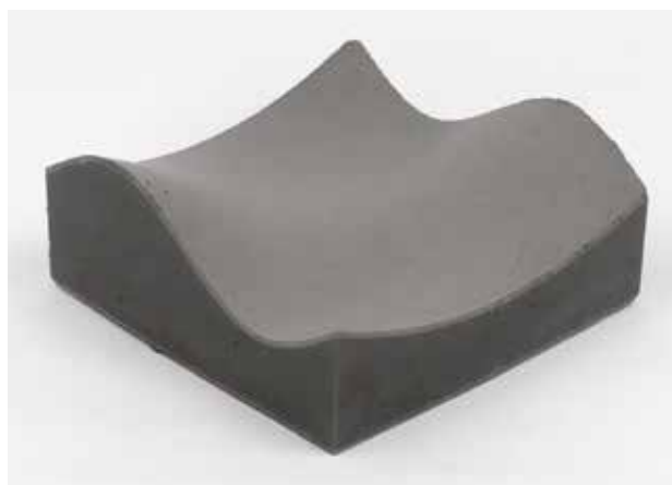
Abb. 60: Betonabguss Keramiksand-Schalung (Münch Versiegler Mikon 399 MC)
