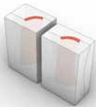
Abb. 112: Kontrollierte Vorformung der Schalungsrohlinge
