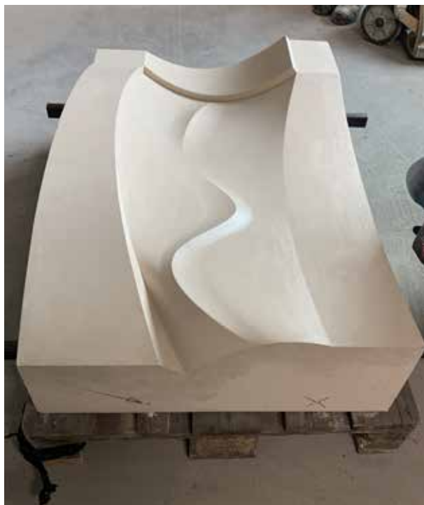
Abb. 117: Oberflächenversiegeltes Schalungselement B vor Ort im Betonfertigteilverwerk „Runkel Fertigteilbau GmbH“
