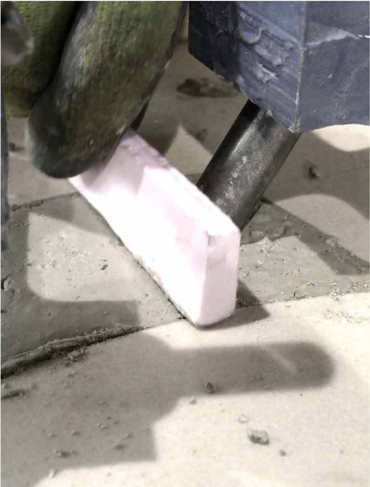
Abb. 127: Abziehen des überschüssigen Betons (ELO)
