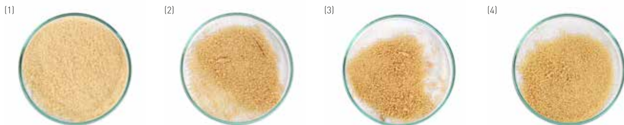
Abb. 94: (1) Span im Ausgangszustand (WEHO 500) (2) Rückführung mit Schredder-Werkzeug A (3) Schredder-Werkzeug B (4) Schredder-Werkzeug C
