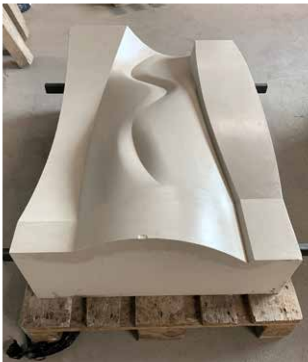
Abb. 116: Oberflächenversiegeltes Schalungselement A vor Ort im Betonfertigteilverwerk „Runkel Fertigteilbau GmbH“
