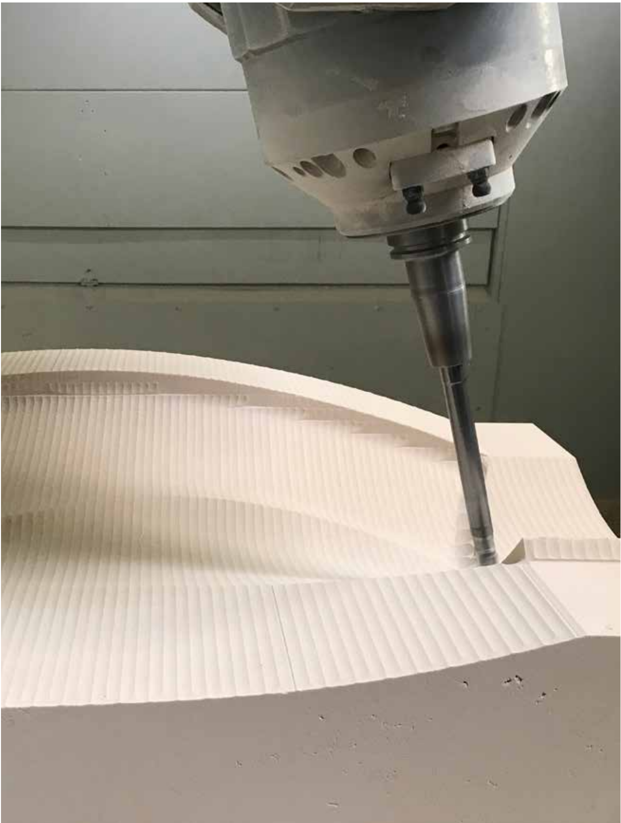
Abb. 53: Schruppen von Keramiksand-Schalungen „Maus Modellbau GmbH“
