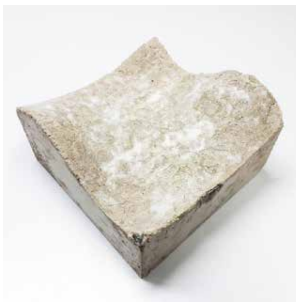
Abb. 101: Abguss Trennmittel „Mirror Wax liquid“ (Elo Beton)
