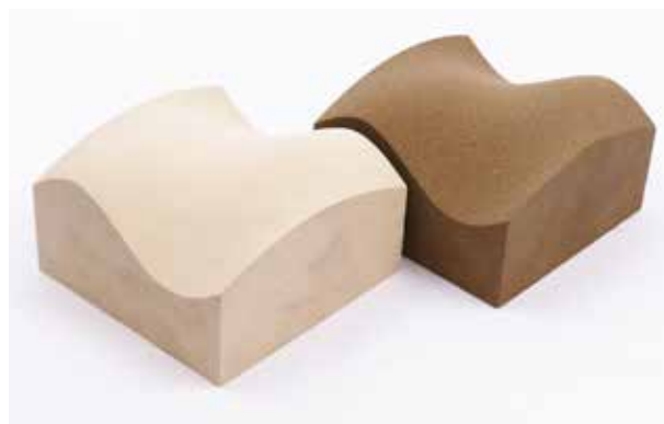
Abb. 92: Keramiksand-Schalungen vor und nach mechanischer Rückführung (links: Neusand; rechts: Altsand)
