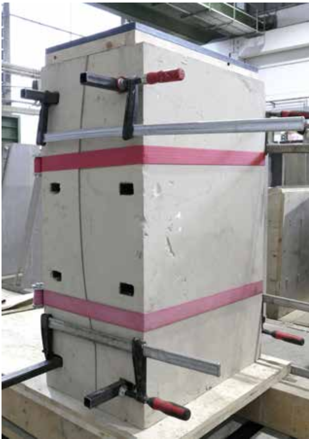
Abb. 120: Vorbereitung der Schalungen zur Betonage (ELO)
