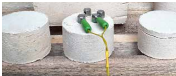
Abb. 31: Trocknung von Rohrproben in der Trockenkammer (drywoodboxx)
