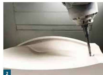
Herstellung des großmaßstäblichen Demonstrators der Sandschalung: 1 Formherstellung, 2 Fräsen der Schalung und 3 Schalungsdetail
