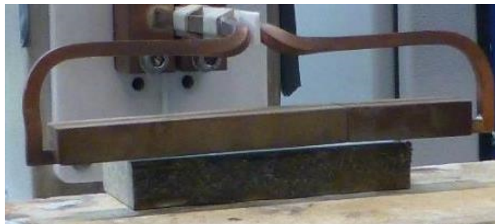
Abbildung 30: Linien - Induktor mit einfacher Spule die von einem Ferritmantel umgeben ist und sich direkt über der Klebstoffuge befindet
