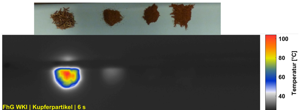
Abbildung 23: Gleichzeitige induktive Anregung von Kupfer-Spänen - extra fein, Kupferpulver 315 \mu\text{m} , Kupferpulver - 63 \mu\text{m} und Kupferpulver - 38 \mu\text{m} (oben) und deren Temperaturentwicklung (unten).
