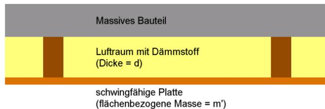
Plattenschwinger lassen sich ebenfalls durch verkleinern der Abmessungen skalieren, wobei insbesondere die flächenbezogene Masse der Platte korrekt skaliert werden muß. Auch hier muß der Stömwiderstand angepaßt werden. Abb. 41 zeigt den spektralen Verlauf der Absorption eines Plattenschwingers im Maßstab 1:1 und dessen im Maßstab 1:10 skalierte Version in Varianten mit und ohne angepaßte Dämpfungsschicht dargestellt.
