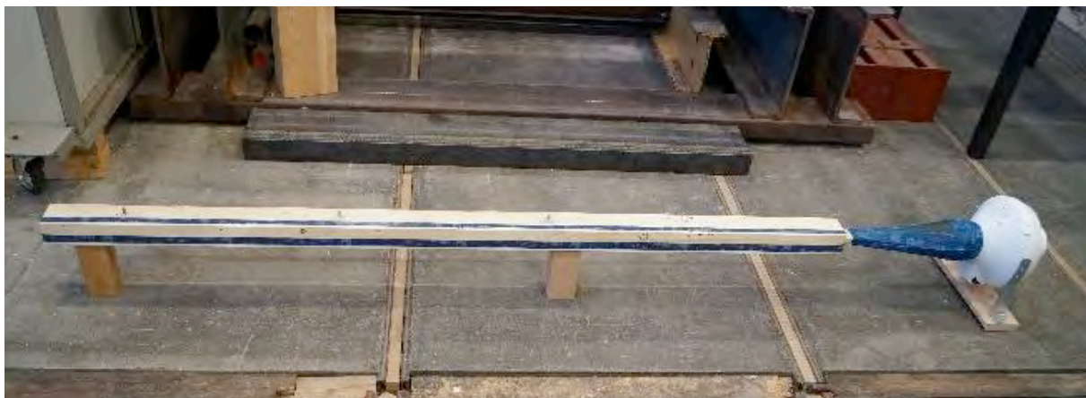
Abbildung 32 Versuchsaufbau zur Ermittlung der Sandkornrauigkeit k_s (Eckel, 2021)
