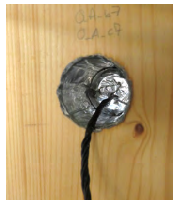
Abbildung 161 In 70 mm Tiefe verbauter Kombisensor ( O\_A\_b7 und O\_A\_c7 )
