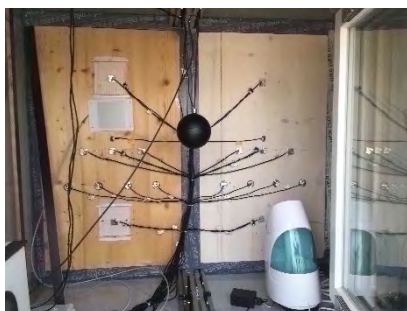
Abbildung 199 Messaufbau für die Experimente in Kubus Ost. Der Befeuchter wurde für diese Periode nicht benutzt.
