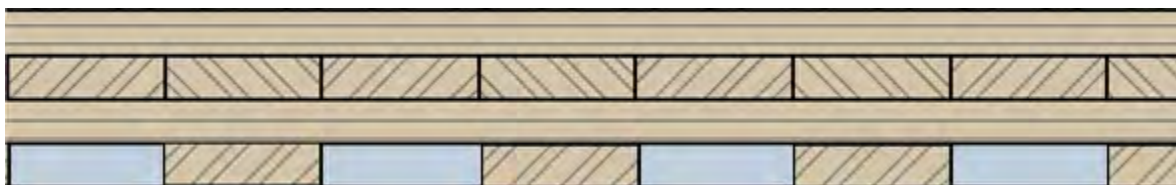
Abbildung 13 Zwischenprodukt: Brettsperrholzgrundprodukt mit aufgeklebter Kanalschicht (eigene Darstellung)
