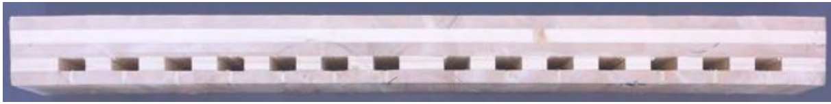
Abbildung 26 Prototyp B mit Vollholzplatte als Deckschicht (Mindrup, 2019)
