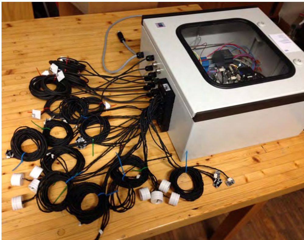
Abbildung 45 Messtechnik Schaltschrank mit Sensoren
