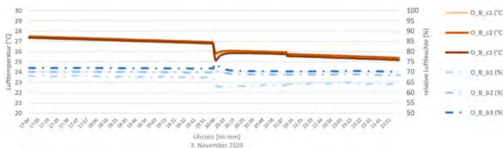
Abbildung 172 Kurzzeitiger Luftwechsel (zwei Minuten) und resultierende relative Luftfeuchten und -temperaturen in drei verschiedenen Höhen vor dem Referenz-Testelement B, BSP_02 abgedichtet, Kubus Ost.
