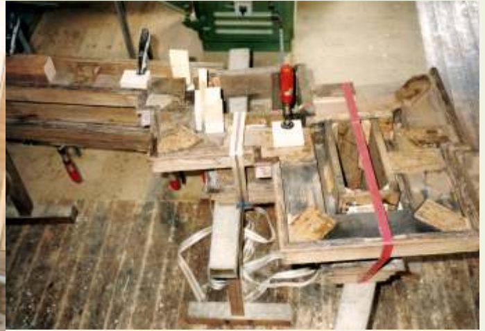
oben: Verleimen am Oberteil (Bekrönung) unten: Einpassen und Verleimen des Tabernakels
