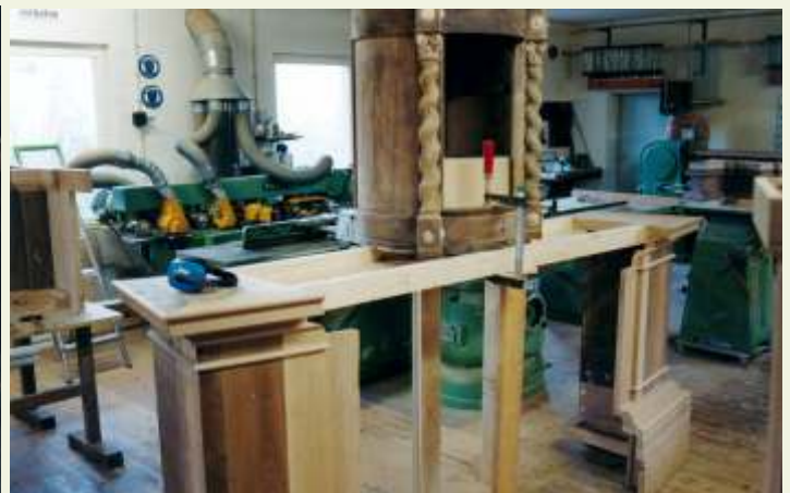
unten: Der Einsatz für das Tabernakel wurde verleimt und eine neue Abdeckung erstellt.
