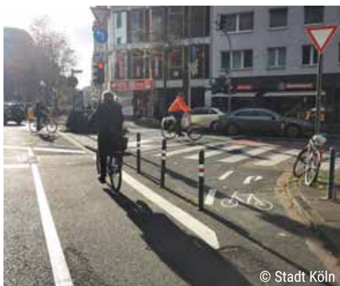
Beispiel für eine Maßnahme im Rahmen des städtischen Projekts zum Abbau freier Rechtsabbieger: Mehr Verkehrssicherheit durch Abpollerung an der Einmündung der Kamekestraße in die Venloer Straße.
