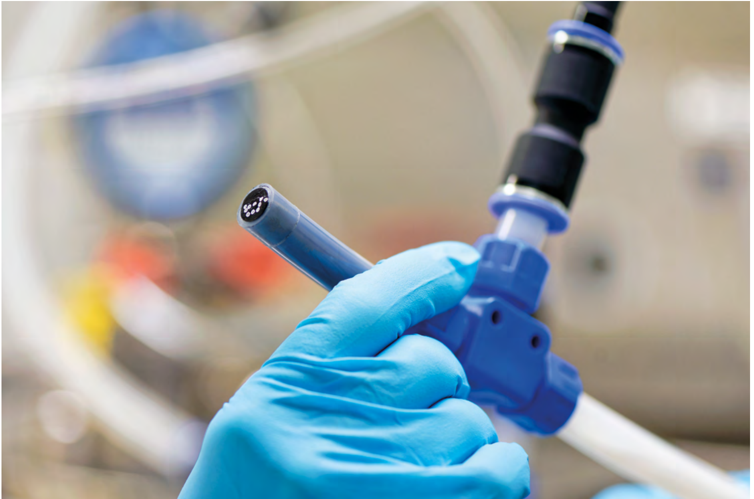
Bild 2: Im dem hier dargestellten Membranmodul sind mehrere Hohlfasern als Membranstützstruktur verbaut. Diese werden am Lehrstuhl für Chemische Verfahrenstechnik mit Polyelektrolyten beschichtet, um die Trenneigenschaften der Membranhohlfasern für die Aufreinigung von Recyclingwasser von Lithium-Ionen Batterien anzupassen.
