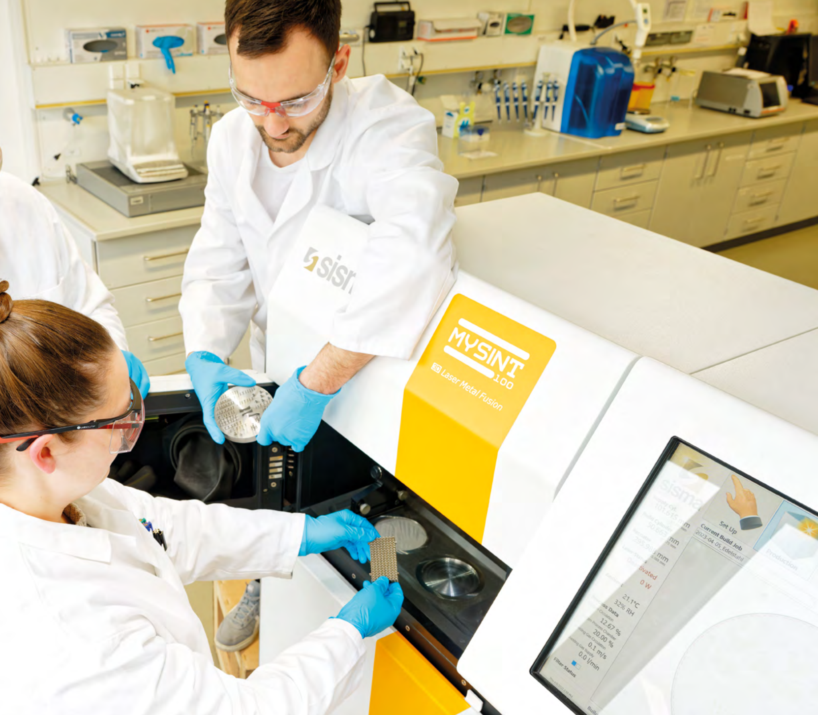
Bild 1: Mithilfe eines 3D-Druckers, der das „Selective Laser Melting“ Verfahren nutzt, können komplexe und neuartige Elektroden aus Edelstahl, Kupfer oder Nickel hergestellt werden. Foto: Peter Winandy
