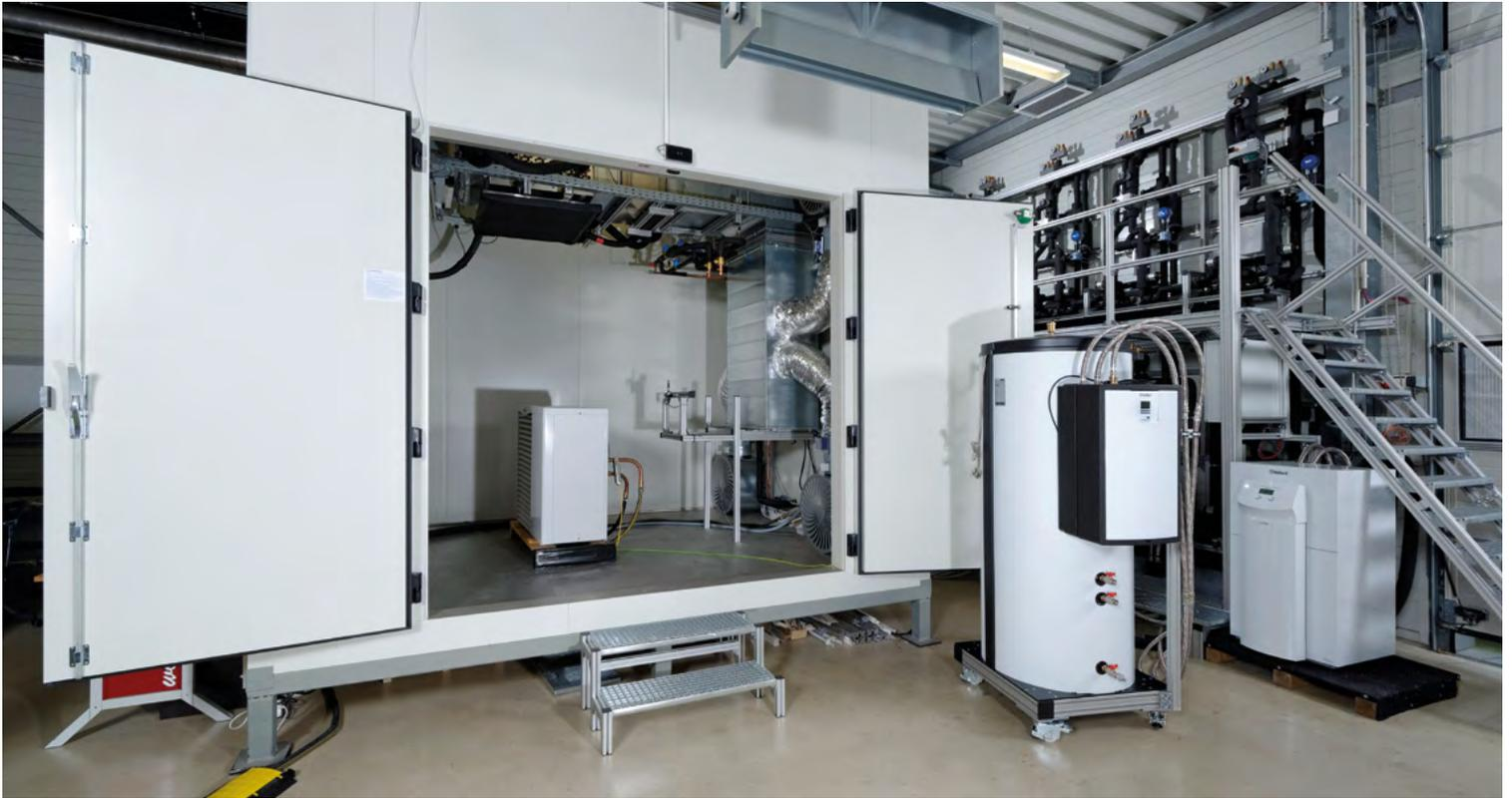
Bild 1: Aufbau eines Hardware-in-the-Loop-Prüfstands mit Klimakammer und Hydraulikstation zur Vermessung von Wärmepumpen unter dynamischen Betriebsbedingungen
