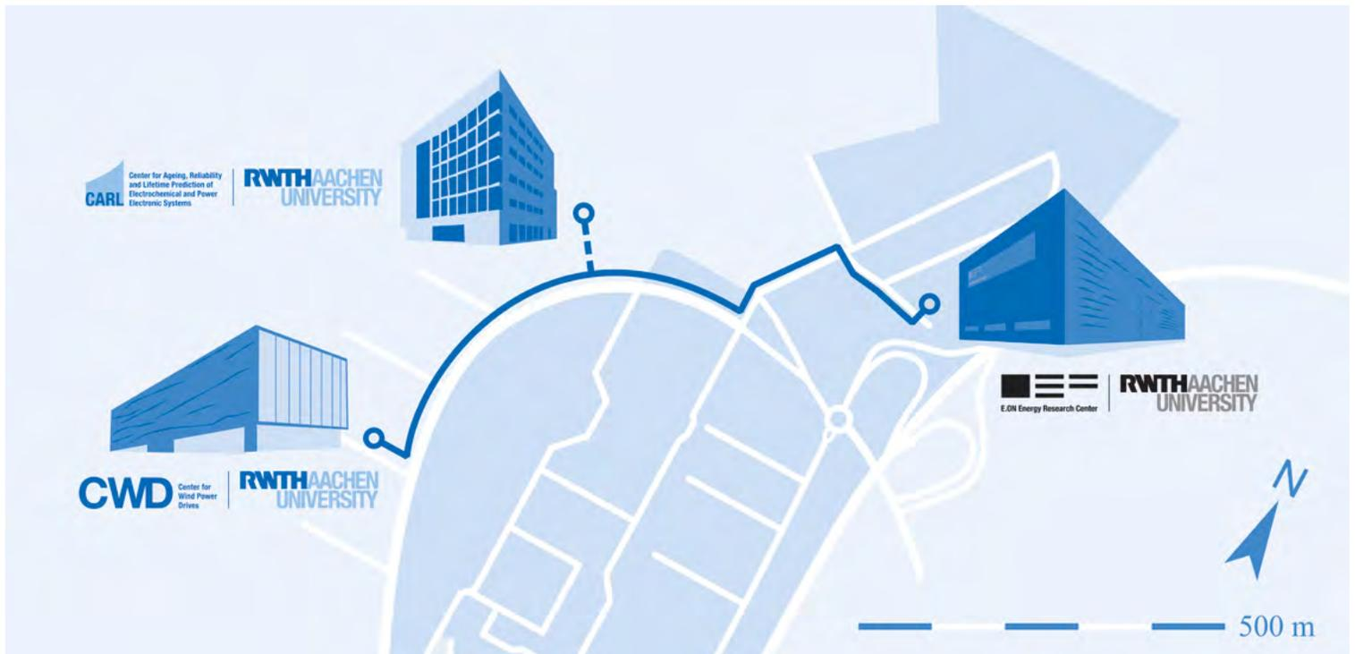
Bild 3: Trassenverlauf (in blau) des 5kV/5MW-DC-Mittelspannungsnetzes (MVDC) am Campus Melaten in Aachen. Ein flexibler Austausch der elektrischen Energie zwischen dem Center for Wind Power Drives (CWD) und dem Institute for Power Generation and Storage Systems (PGS) am E.ON ERC wurde realisiert.
