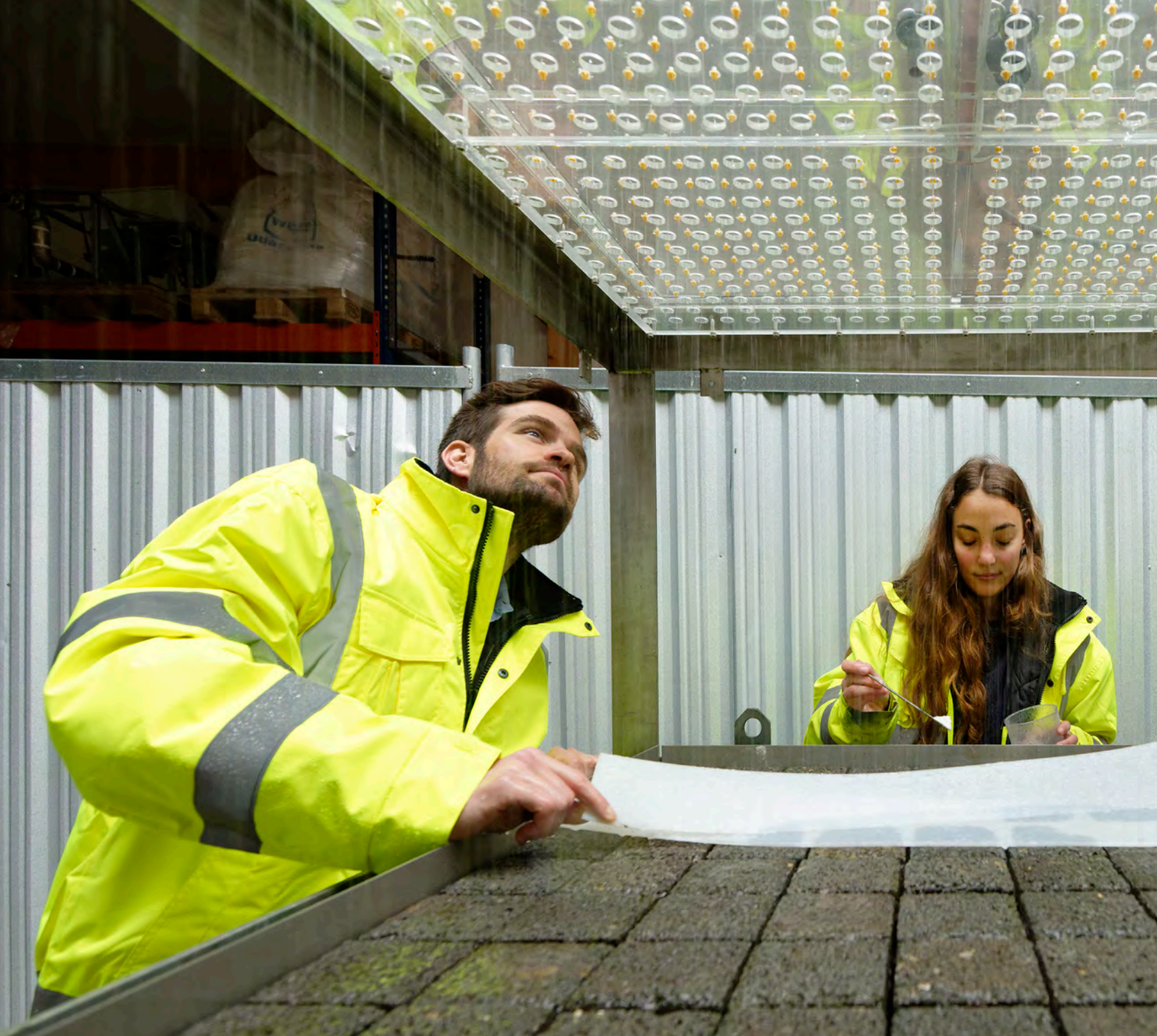
Bild 3: Untersuchungen zum Abflussverhalten von Niederschlägen auf teildurchlässigen Flächen ermöglichen die Ermittlung des Potenzials für eine Zwischenspeicherung von Niederschlag in urbanen Gebieten
