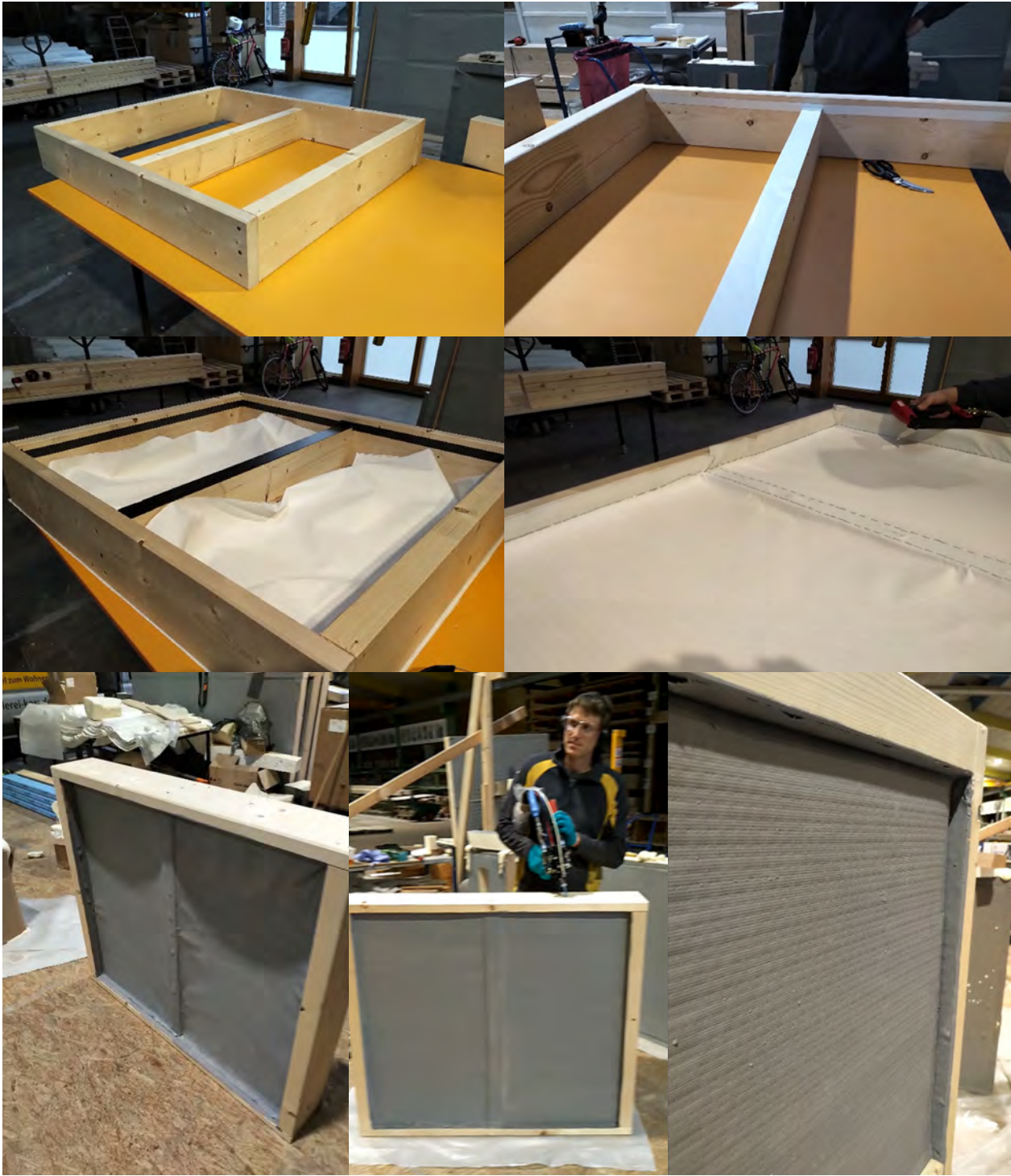
Bild 2: Herstellung der Wandmodule (Obere Reihe: Holzrahmen, Rahmen mit Klebebändern; Mittlere Reihe: Aufbringen des 3D-Gewebes, Befestigung des Gewebes; Untere Reihe: Rahmen vor dem Befüllen, Füllvorgang, Fertiges Rahmenmodul.)
