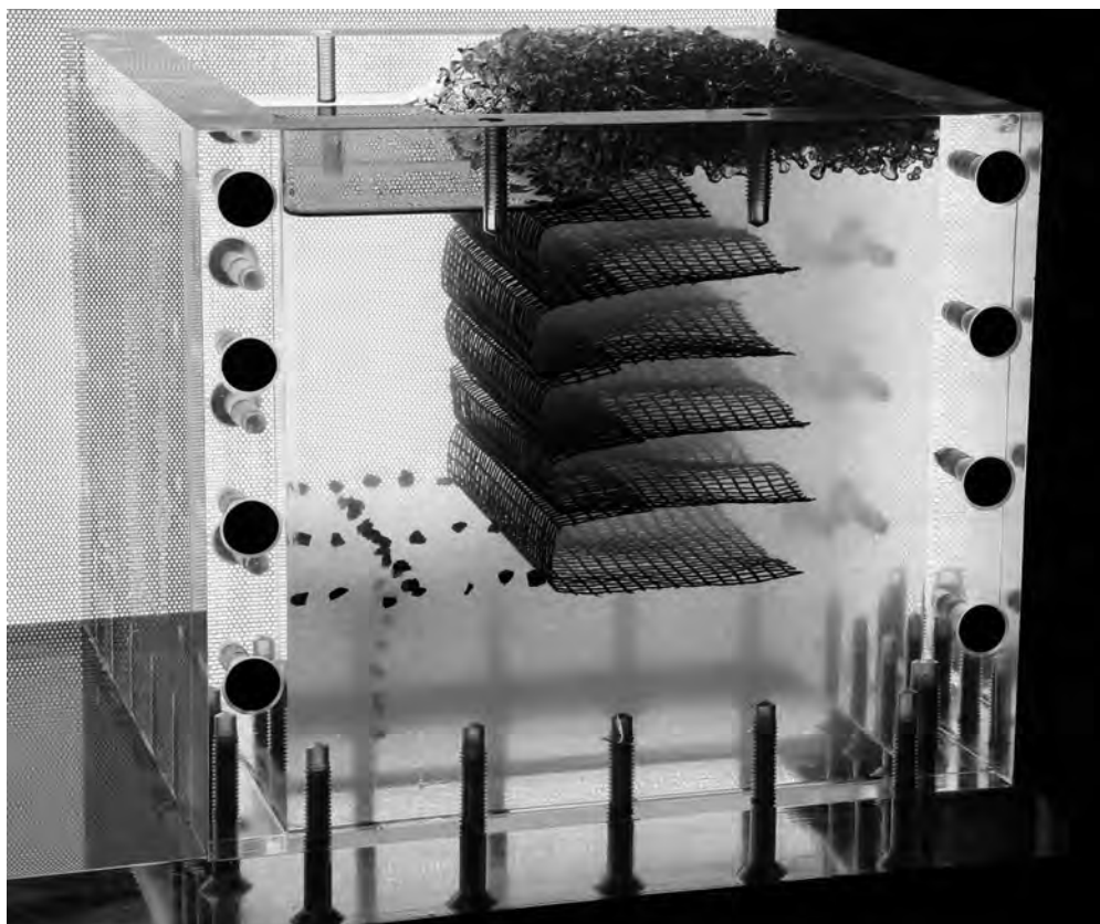
Bild 6: Kleinmaßstäbliche geogitterbewehrte Stützkonstruktion im transparenten Boden
