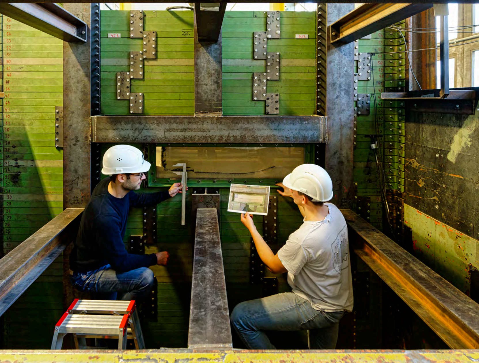
Bild 1: Großversuch zur Untersuchung des Trag- und Verformungsverhaltens von geogitterbewehrten Stützkonstruktionen – Analyse der Verformungen am Wandfuß nach der Belastung Foto: Peter Winandy
