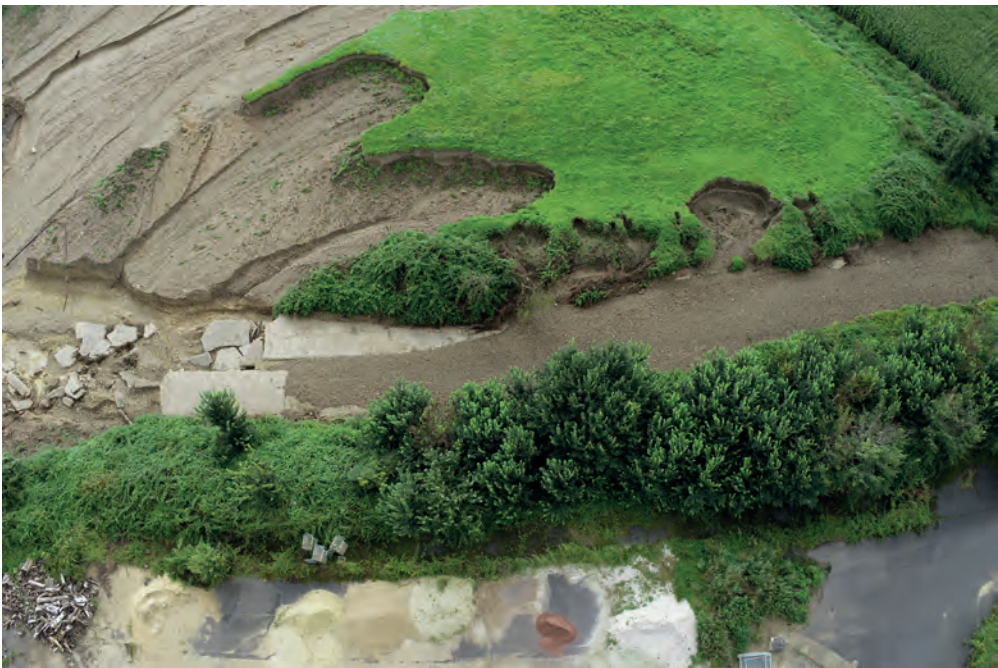
Bild 4: Drohnenaufnahmen vom 16.07.2021 und 22.08.2021. Oben: Detailfoto zur rückschreitenden Erosion mit Überblick über das neu geschaffene Erosionstal mit Akkumulation auf einer ersten Abbausohle. Mitte: Rückschreitende Erosion nach dem Überlauf der Inde. Unten: Beginnende rückschreitende Erosion. Fotos: Institut für Wasserbau und Wasserwirtschaft
