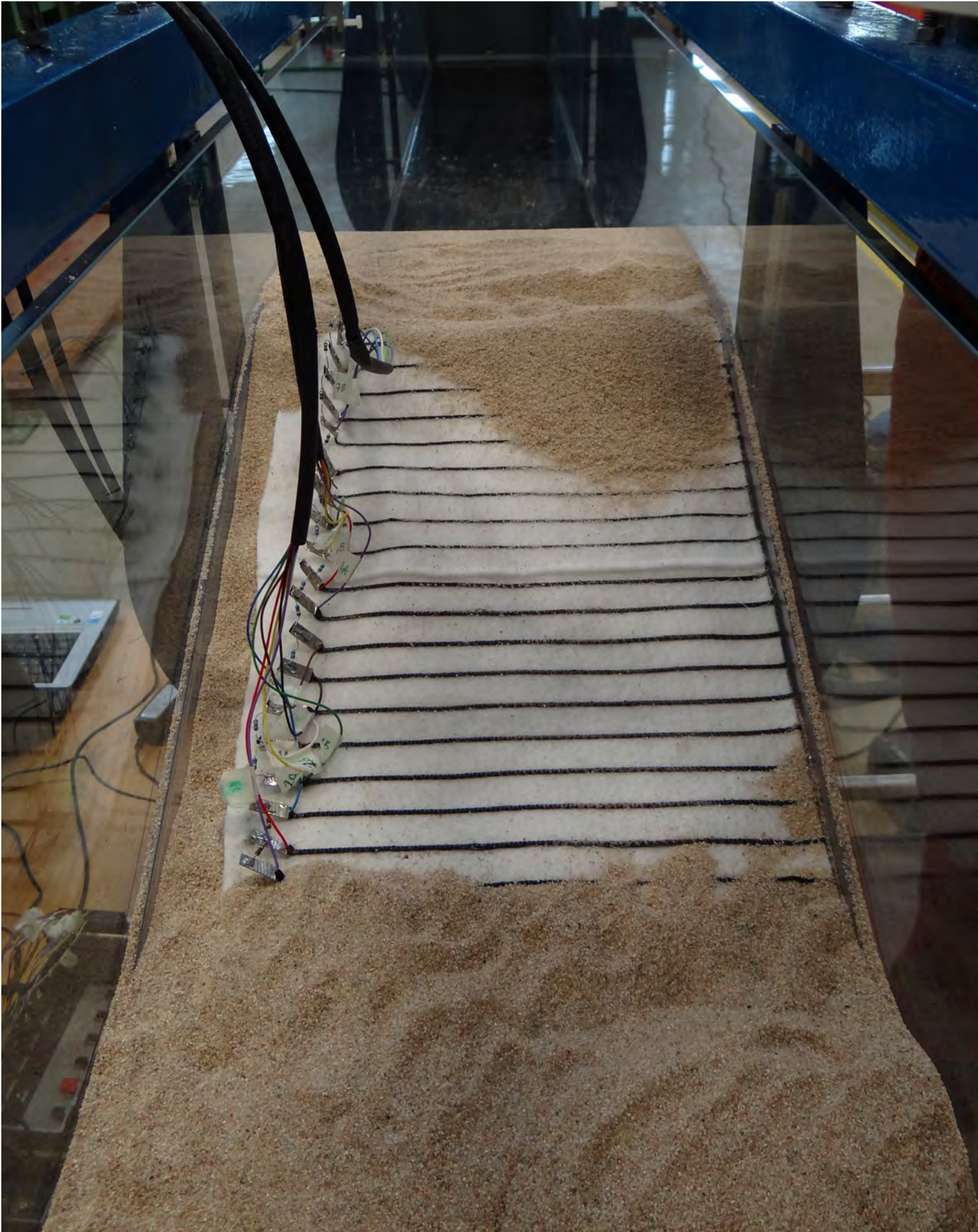
Bild 2: Ein Geotextil mit integrierten Sensoren wird am Versuchsstand teilweise im „Deichkörper“ verbaut, hier eine erste Version des Sensor-Geotextils während eines kleinmaßstäblichen Vorversuchs.
