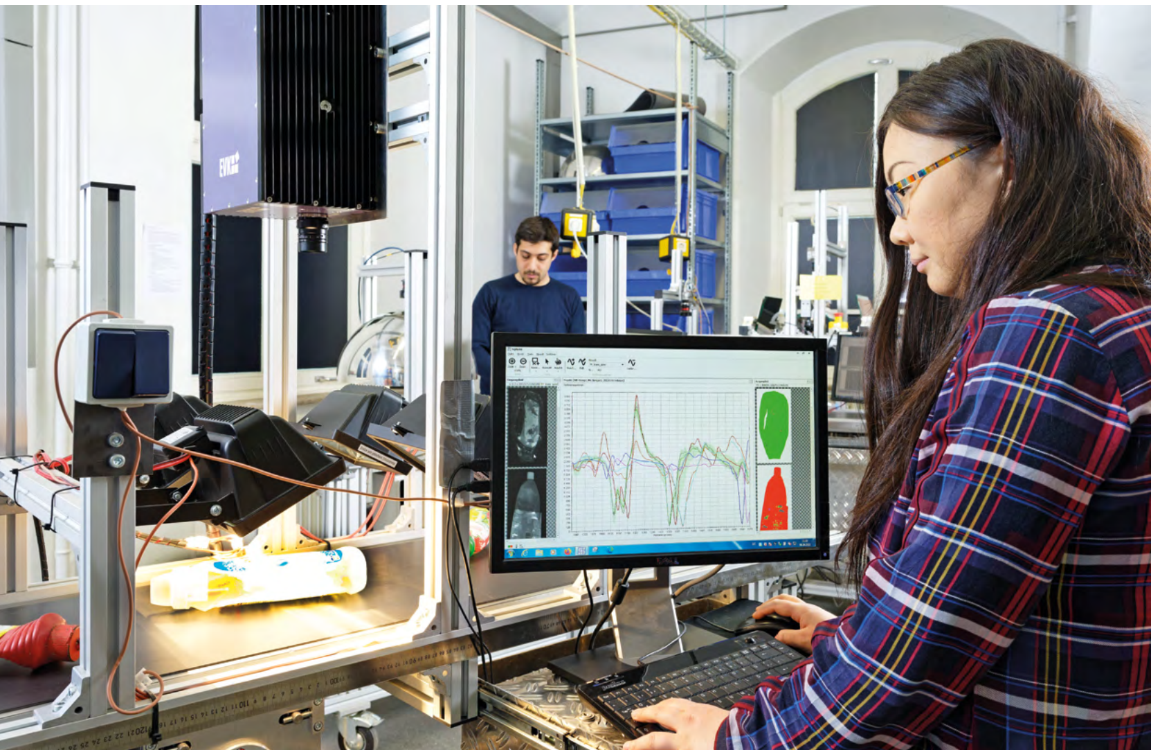
Mit Hilfe eines NIR-Sensors werden Kunststoffe charakterisiert. Foto: Peter Winandy
