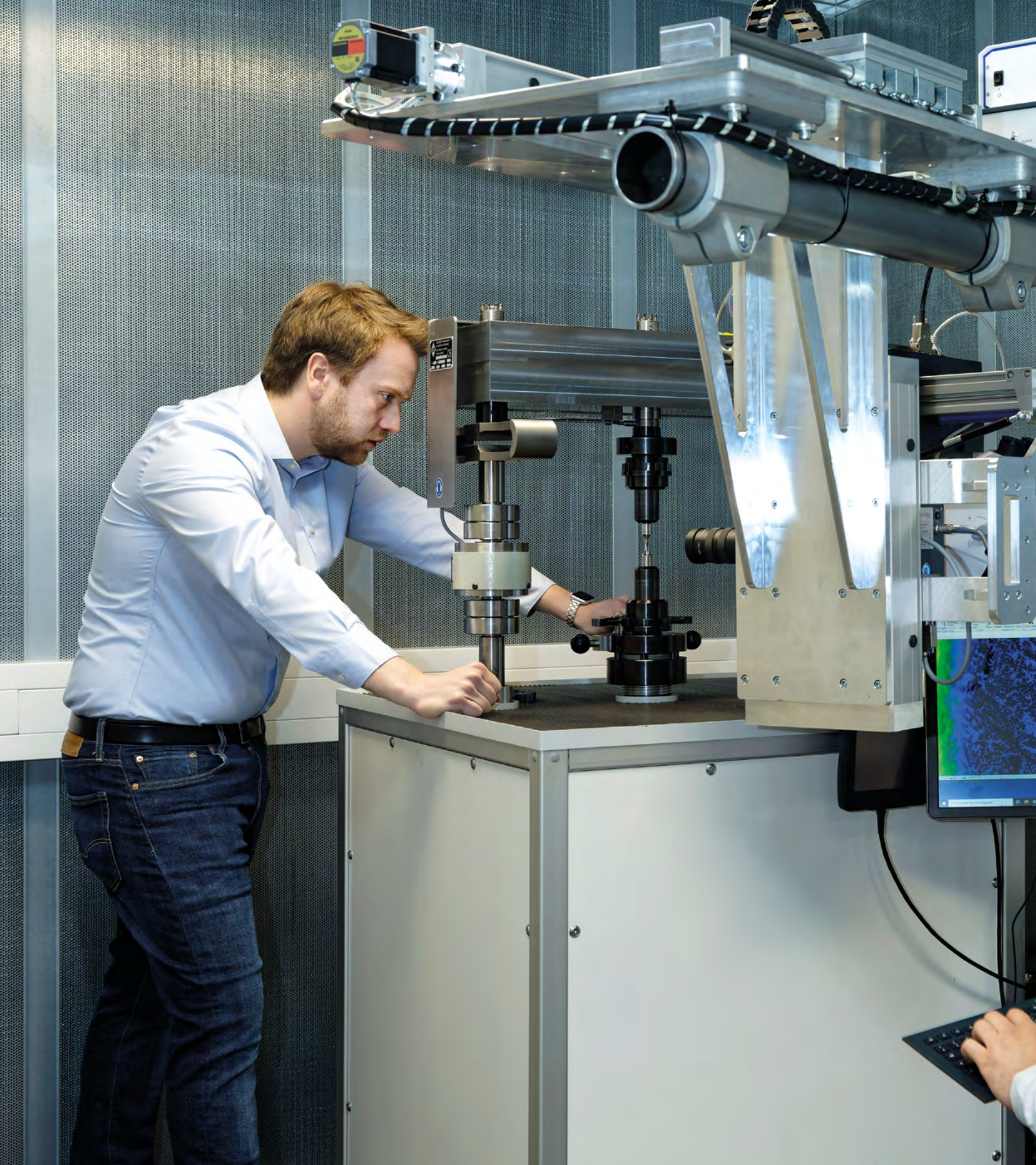
Bild 5: Bestimmung der Rissinitiation durch korrelative Mikroskopie und Thermographie. Foto: Peter Winandy
