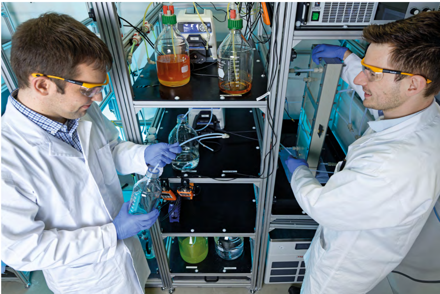
Bild 6: Probenahme am Membranmodul zur elektrochemischen pH-Wert-Einstellung
