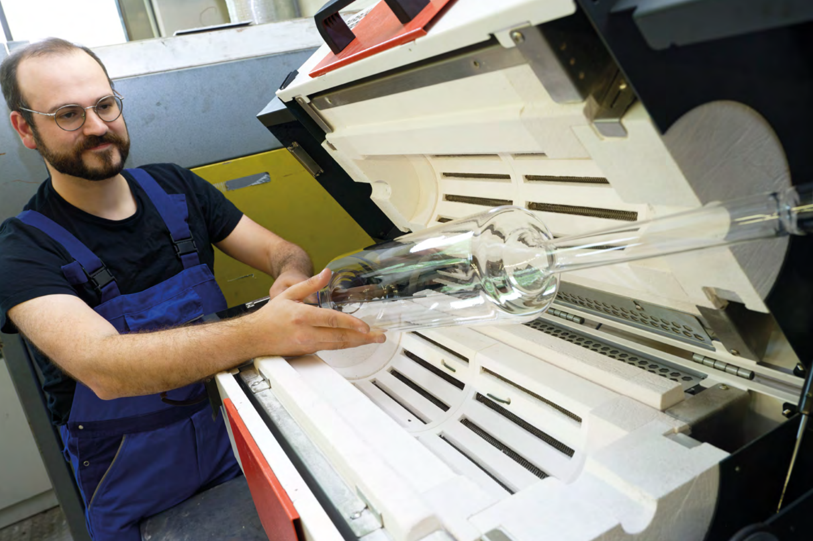
Bild 1: Thermische Vorbehandlung im Labormaßstab in einem Drehrohrföfen
