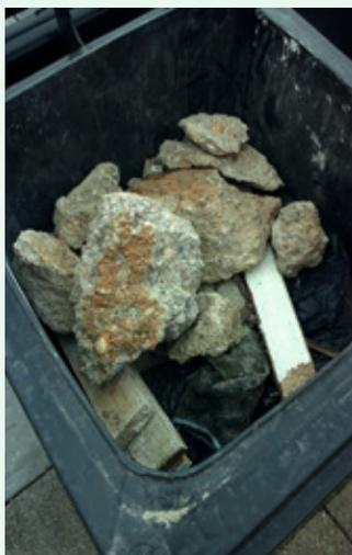
Unter Bauschutt versteht man alles, was auf einer Baustelle beim Neubau, Ausbau und beim Abbruch anfällt. Hierunter fallen mineralische Abfälle und Baumaterialien, wie zum Beispiel Beton, Backsteine, Ziegel, Klinkersteine und Mörtelreste, aber auch Fliesen, Glasbausteine, Keramik oder Sand. Diese Materialien haben auch in geringen Mengen weder etwas in der Bio- noch in der Restmülltonne zu suchen.
