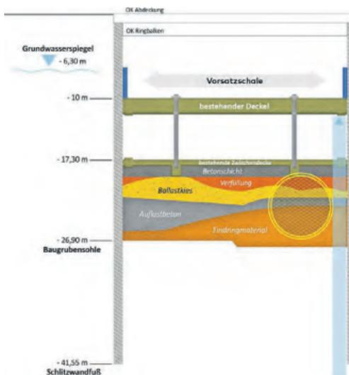
Die Grafik zum Verständnis der Baugrube am Waidmarkt. Die Schlitzwände reichen über 41 Meter tief. Der Kreis in der Grafik zeigt die Tunnelröhre an. Grafik: KVB
